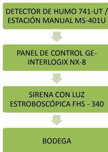
Figura 4.11 Diagrama de la arquitectura del sistema con sus componentes específicos en su modo de operación
