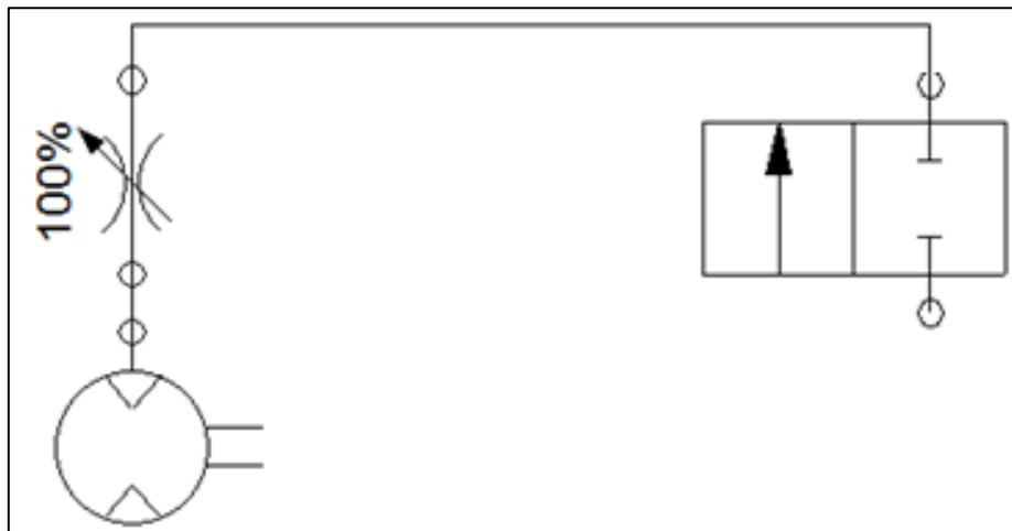
Figura 36: Diagrama de conexión entre la bomba de agua y la electroválvula
