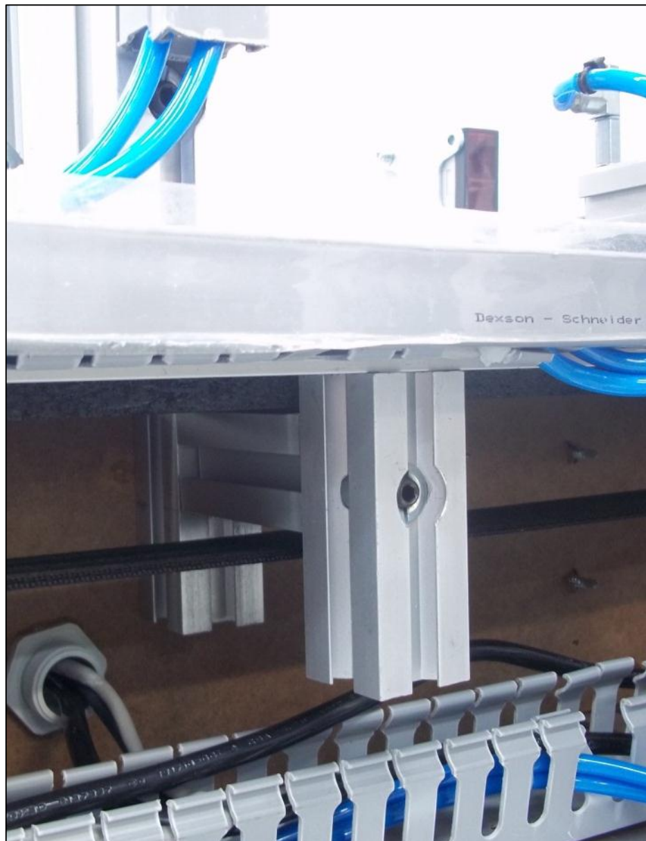
Figura 71: Estructura módulo de sellado
