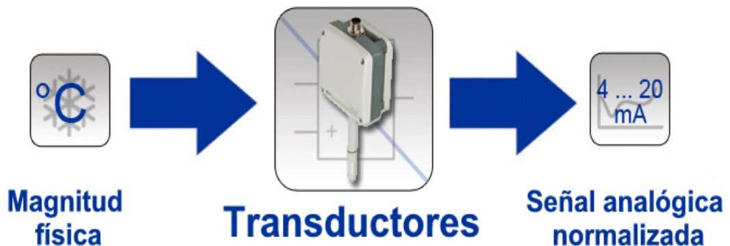
Figura 2.8 Funcionamiento de un transductor
