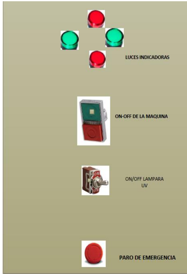
Figura 38. Diseño del tablero de control
