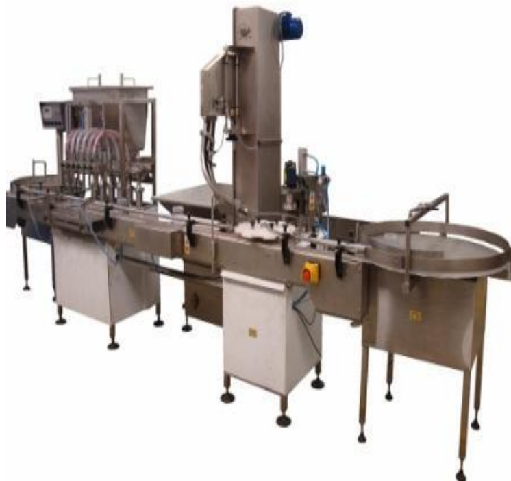
Figura 22. Dosificadora automática de líquidos horizontal con banda transportadora.
