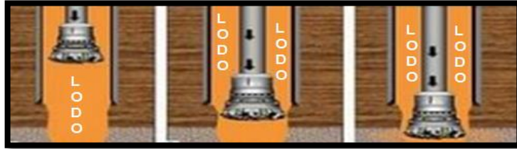
Fig. 23 Enfriamiento y Lubricación de la Broca
