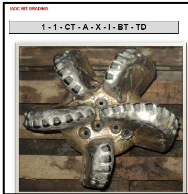
Fig. 30 Calificación de la Broca – Smith (IADC)
