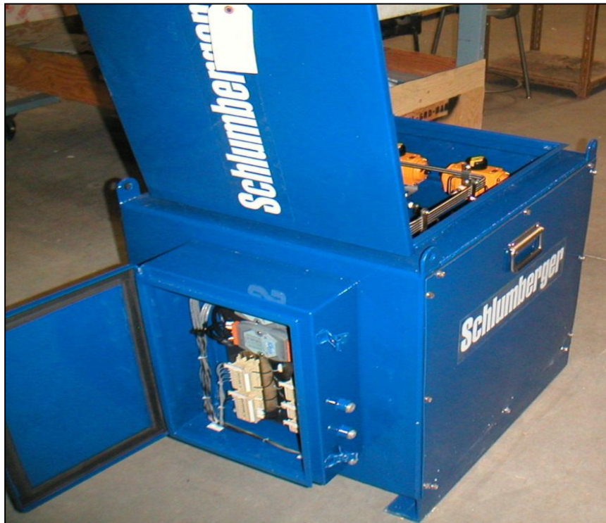
Figura 23. Unidad de Potencia Hidráulica (HPU).
