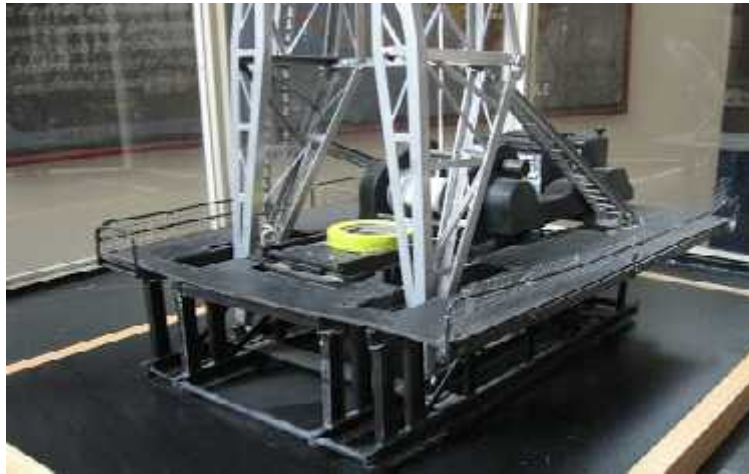
FIGURA 11: Subestructura y Piso del Taladro (PETROBLOGGER, 2014)
