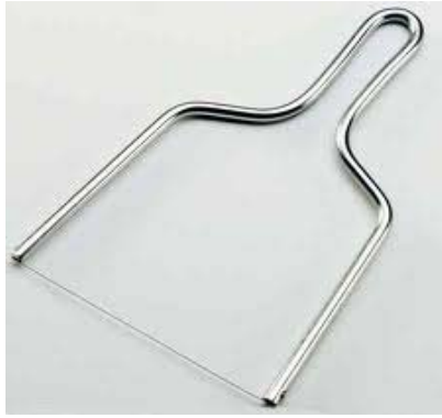
Grafico3: Lira de corte para queso Azul Grafico4: Guillotina de corte para queso Azul
