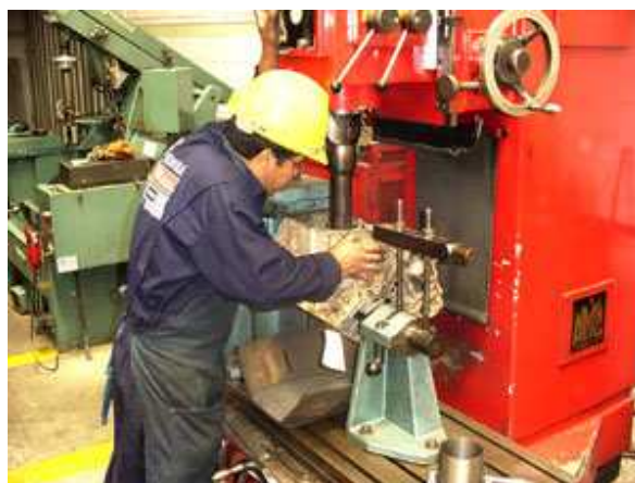
Figura 4.4 Rectificación de block de cilindro
