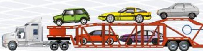
Son plataformas destinadas al transporte de vehículos. No protegen a la carga del medio ambiente y tienen un sistema que permite realizar con rapidez las operaciones de carga/descarga.
