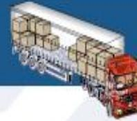
Son vehículos que por sus características permiten transportar todo tipo de carga seca que no necesite control de temperatura, protegiéndola del medio ambiente.
