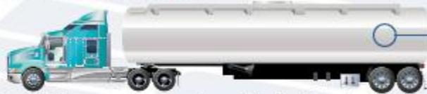
Son vehículos que cuentan con un tanque destinado al transporte de carga líquida o gaseosa. Algunas de estas cajas se encuentran divididas en varios tanques pequeños mediante compuertas y otros, destinados al transporte de líquidos, poseen compuertas con agujeros para el paso del mismo.
