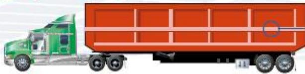
Estos vehículos, que pueden ser de caja abierta o cerrada, se utilizan para transportar principalmente carga a granel.
