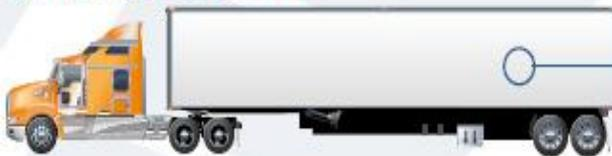
Capacidad máxima de carga de 3.490 pies cúbicos (ft<sup>3</sup>) y peso neto vacío de 25,5 toneladas (Ton).
