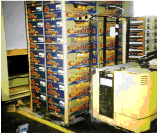
Figura: Carga paletizada y unitarizada / Una sola “Unidad de carga”//Fuente: López M., Díaz G. Diseño y manejo de empaques y embalajes para frutas frescas, 2001.
