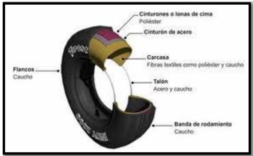
Figura 2.7. Estructura por capas en un neumático
