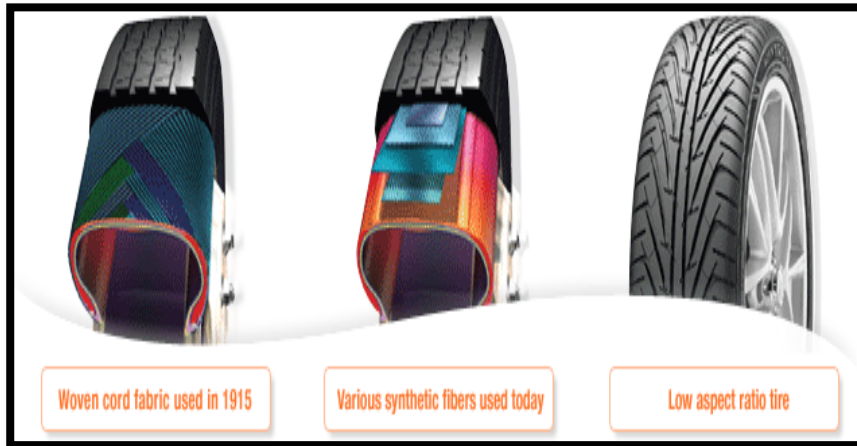
Figura 2.5. Evolución del material de fabricación de las llantas
