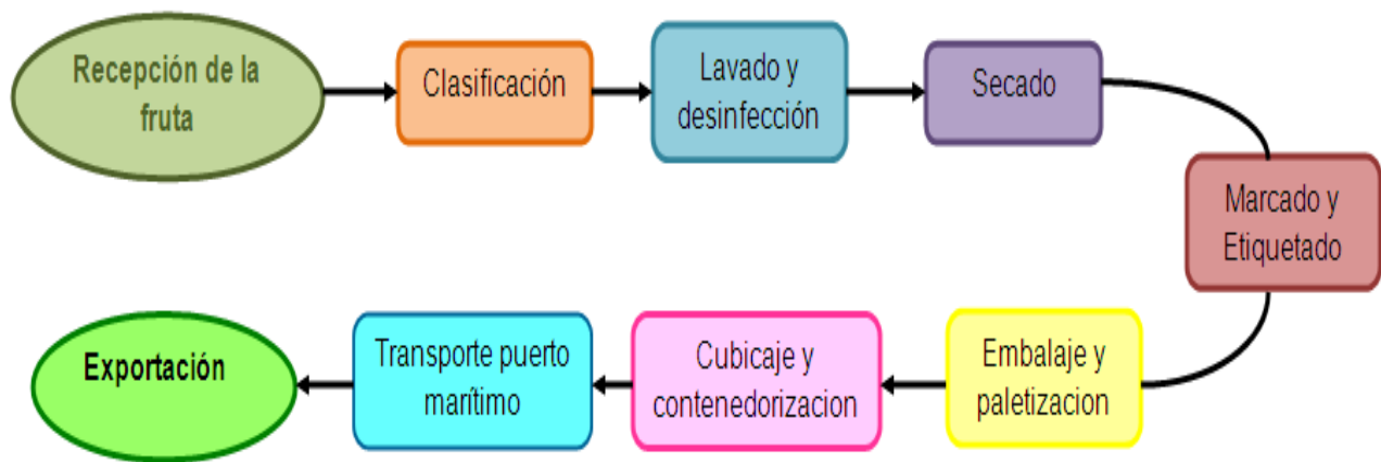
Gráfico N° 5.2 Flujo grama de procesos de la planta
