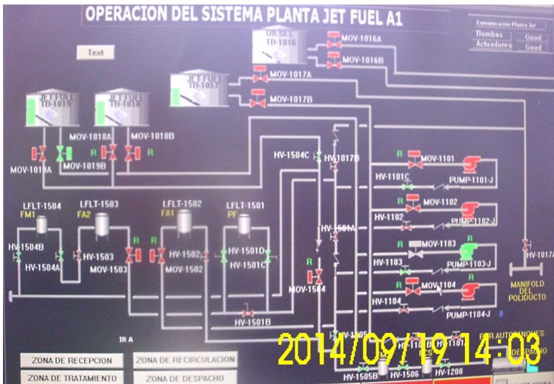
Figura 27: Esquema total de procesos de la planta de Jet del Terminal Beaterio
