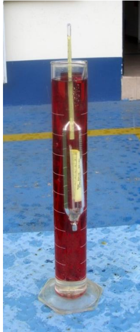
Figura 28: Procedimiento para tomar temperatura y API de muestra en el Terminal Beaterio.
