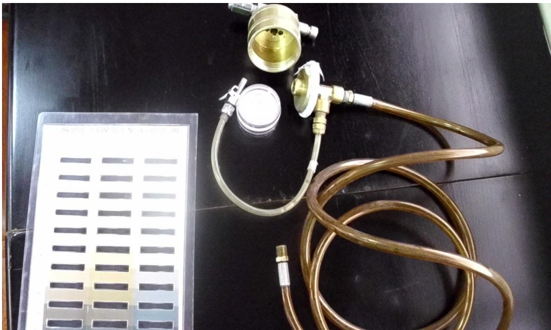
Figura 17: Equipo para realizar el procedimiento Color Millipore
