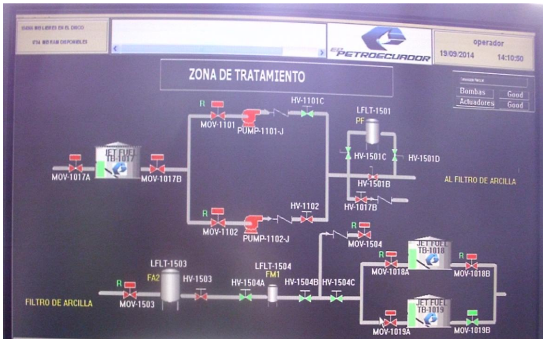
Figura 23: Esquema de la zona de tratamiento de Jet del Terminal Beaterio
