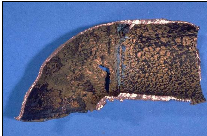
Figura 2.24. Pieza Metálica Afectada a Causa de la Corrosión por Erosión. Fuente. ( www.cdcorrosion.com , 2014)
