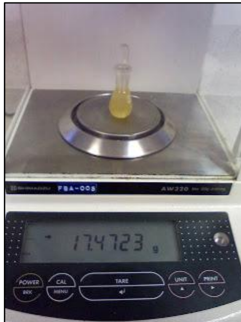
Figura 2.8. Medición de la Densidad de un Líquido.
