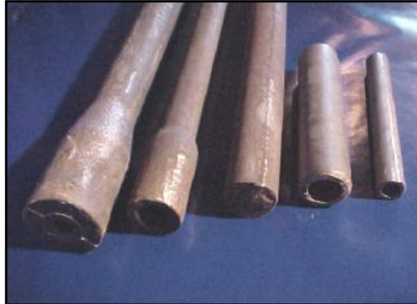
Figura 3.11. Ánodos de Hierro Fundido con Alto Grado de Silicio. Fuente. (Peabody A., 2002)
