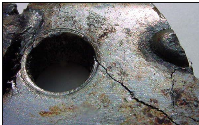
Figura 2.25. Pieza Metálica Afectada a Causa de la Corrosión por Agrietamiento.
