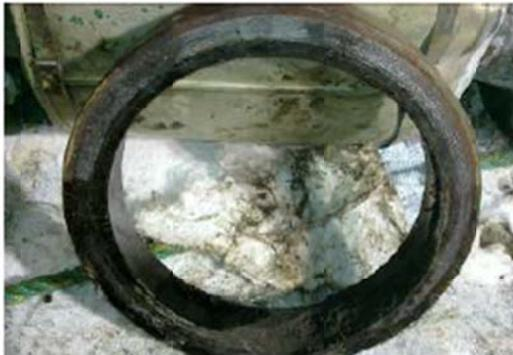
Fotografía No. 11. Falla acople metálico por Corrosión severa Interna Septiembre de 2010 (V-130)
