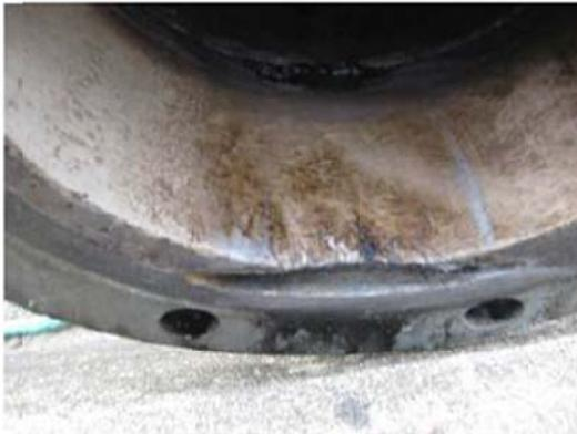
**Fotografía No. 6. Falla Brida por Corrosión severa Interna
