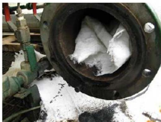
Fotografía No. 3. Falla Brida por Corrosión severa Interna Noviembre de 2009 (V-120)
