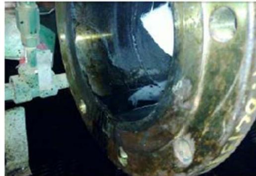
Fotografía No. 12. Corrosión Interna en Brida, falla Septiembre de 2010 (V-130)
