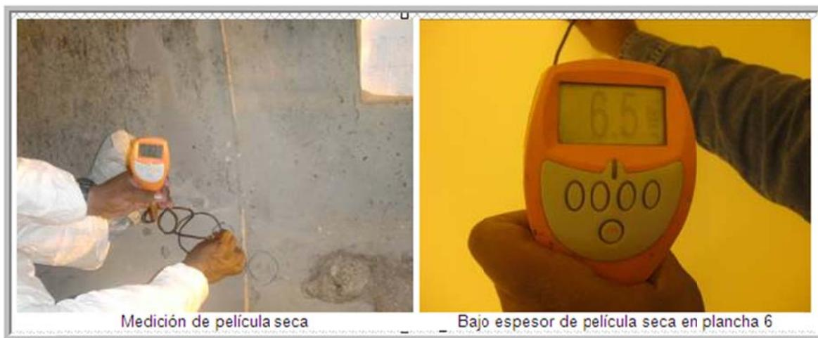
**Figura 42:** Equipo para medición de espesor por ultrasonido
