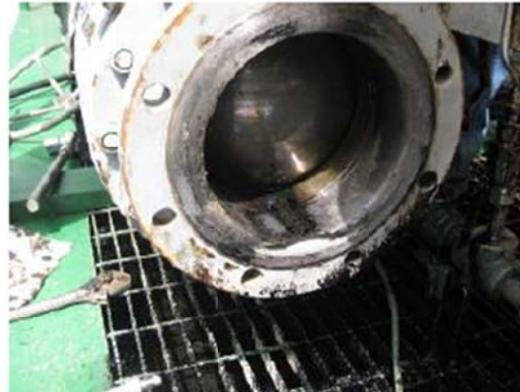
**Fotografía No. 7. Falla Brida Válvula por Corrosión
