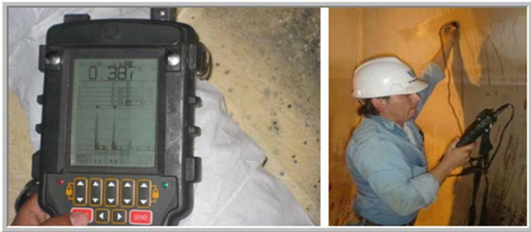
**Figura 43:** Medición de espesores por ultrasonido con Scan A.
