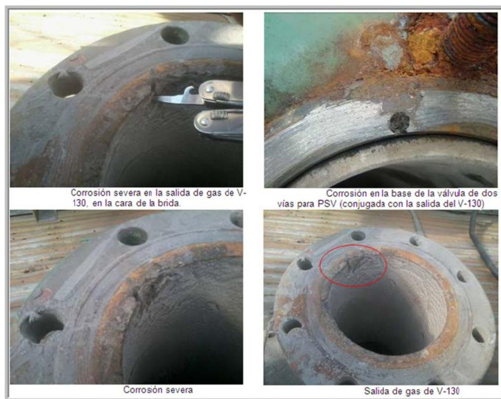
**Figura 45:** Corrosión severa en la salida de gas del separador
