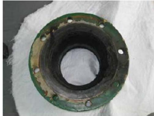
**Fotografía No. 5. Falla Brida por Corrosión severa
