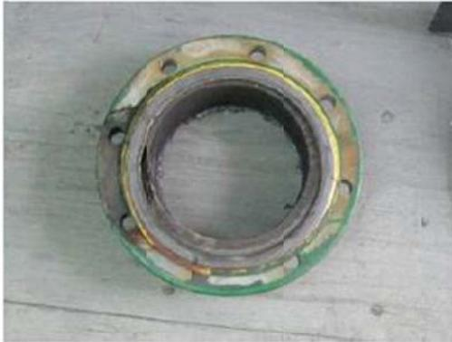
**Fotografía No. 4. Falla Brida por Corrosión severa Interna
