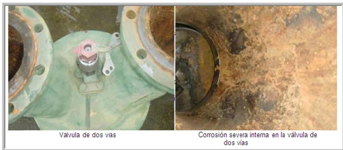
**Figura 46** Corrosión severa en la válvula de 2 vías
