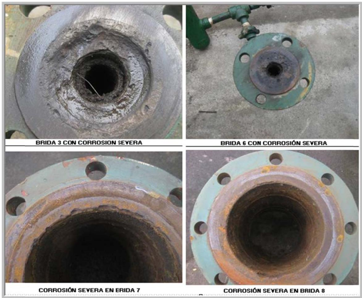
**Figura 40:** Corrosión severa en bridas
