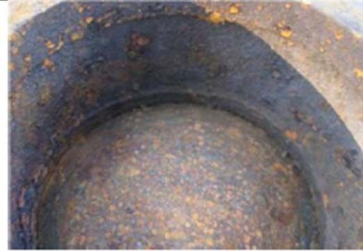
CORROSIÓN GENERALIZADA EN PARTE INTERNA DE VÁLVULA
