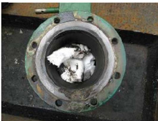
Fotografía No. 2. Falla Válvula por Corrosión severa Interna Noviembre de 2009 (V-120)
