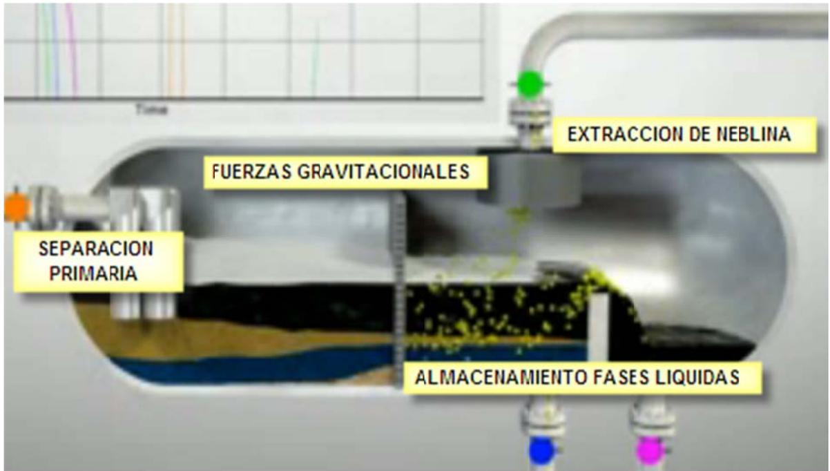
**Figura 8:** Secciones de un separador
