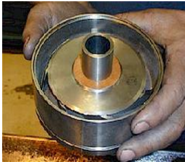
Figura 23: Difusor e impeler con arandela
