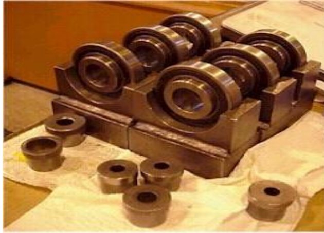
Figura 52: Insertos cojinetes y bloques
