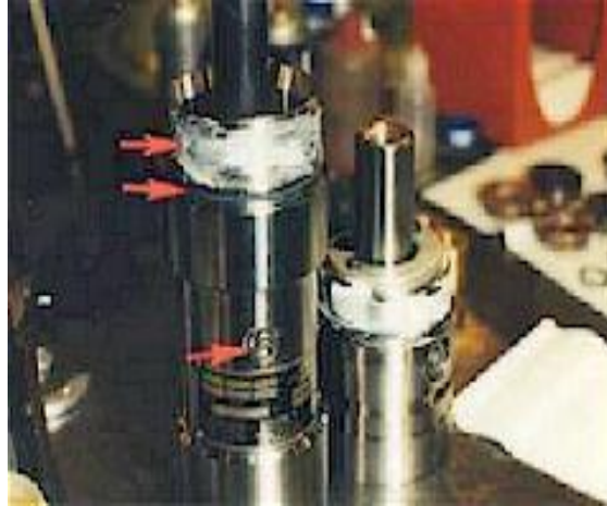
Figura 88: Cabeza upper de motor con su respectivo o-ring y lubricante
