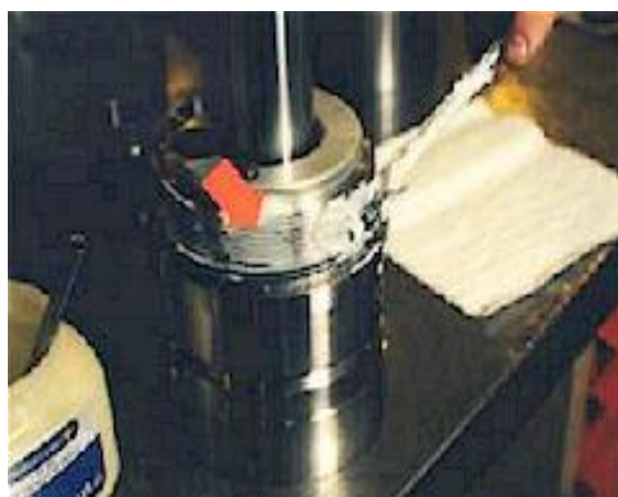
Figura 86: Base de motor con lubricante adecuado
