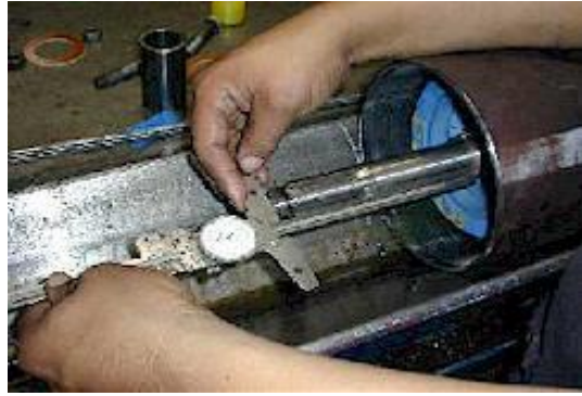
Figura 48: Medición del plug shaft
