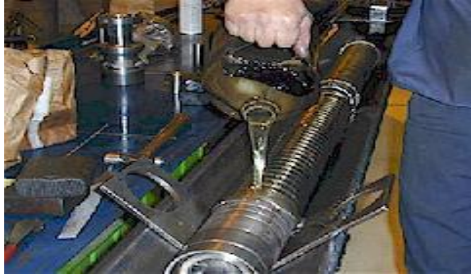
Figura 31: Lubricación del conjunto de etapas
