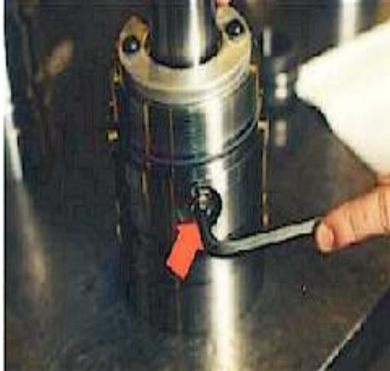
Figura 84: Válvula de llenado sobre la base del motor
