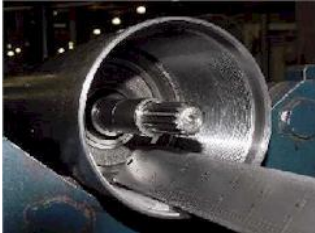
Figura 35: Medida del difusor al final del housing
