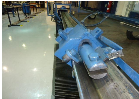
Figura 30: Cadena de empuje de la etapas
