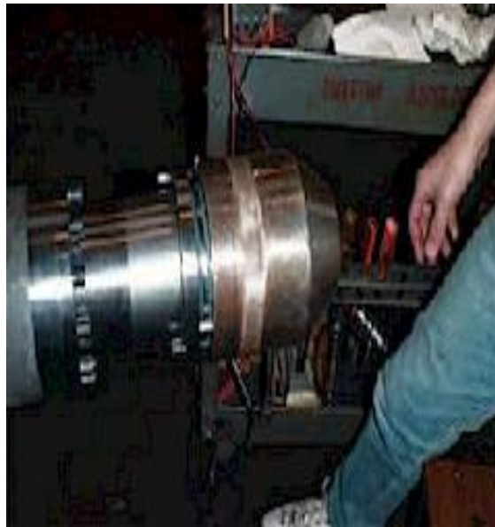
Figura 108: Adaptador base upper para ensayo
