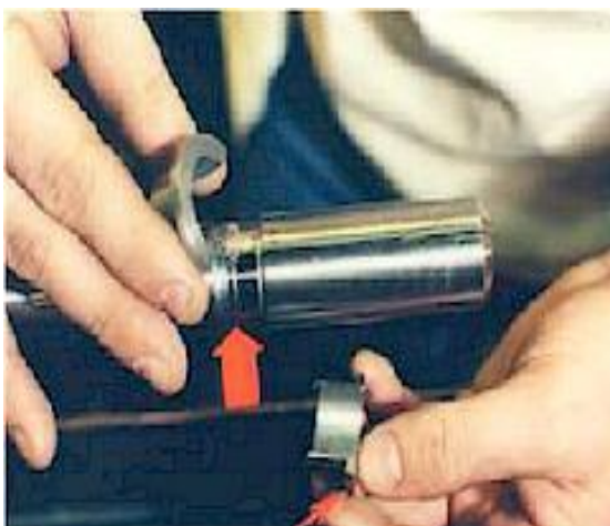
Figura 92: Ensamble de anillo partido sobre el eje
