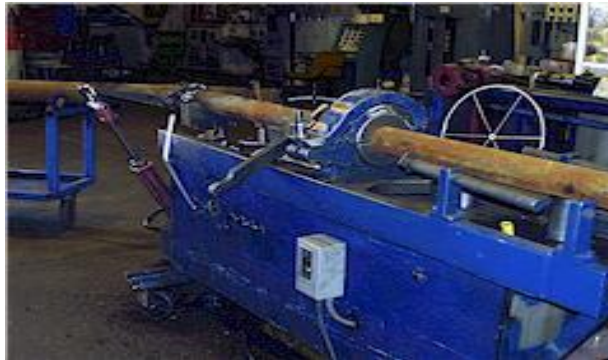
Figura 34: Aplicación de torque en la base
