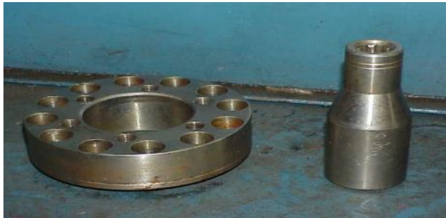
Figura 57: Adaptadores para instalar una bomba serie 400
