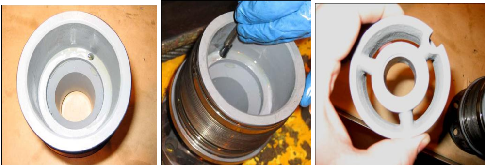
Figura 44: inserto de spacer bearing en la base
