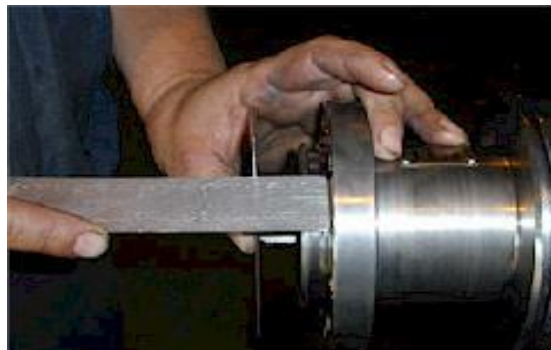
Figura 39: Medición de juego axial
