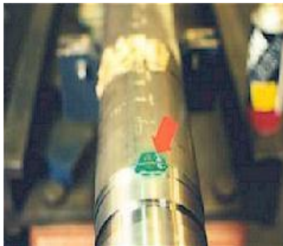
Figura 105: Marcas para identificación del torque
