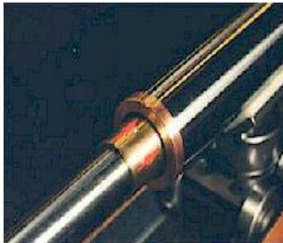
Figura 98: Ensamble del buje sobre la chaveta
