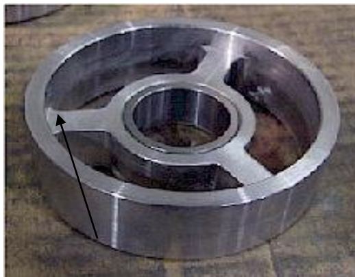
Figura 46: Cojinete con inserto de carburo
