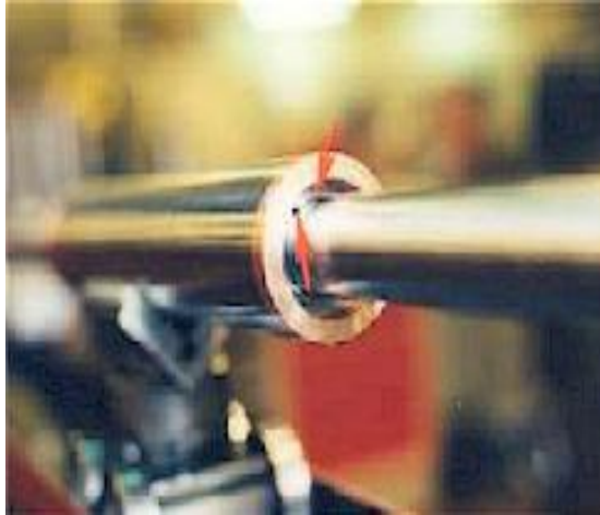
Figura 94: Ensamble de rotor y chaveta sobre el eje
