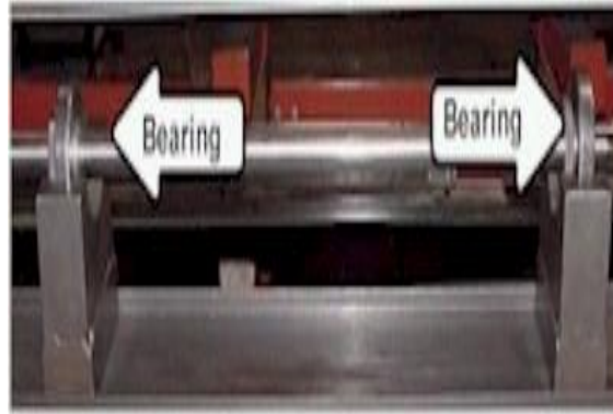
Figura 51: Puntos de soporte para enderezado de ejes (maquina de enderezado Baker Hughes 2011)
