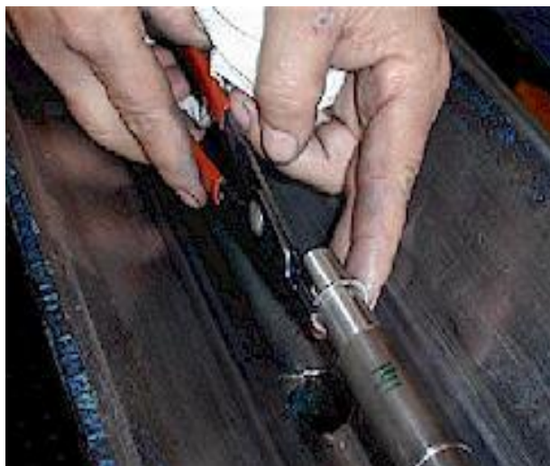
Figura 29: Snap-ring en posición correcta
