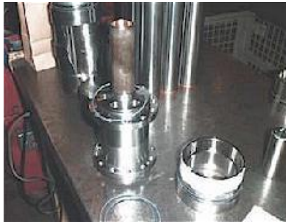
Figura 87: Base upper de motor con su respectivo o-ring
