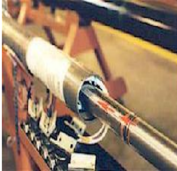
Figura 104: Ensamble del conjunto retórico en el estator
