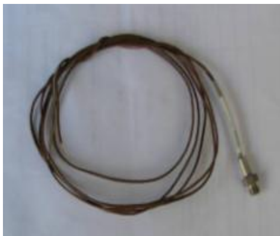
Figura 75: Termocupla para el motor
