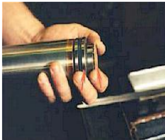
Figura 95: Rotor motor bearing y washer en proceso de ensamble
