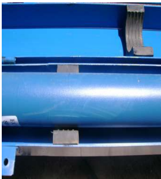
Figura 122: Gomas de soporte según la serie
