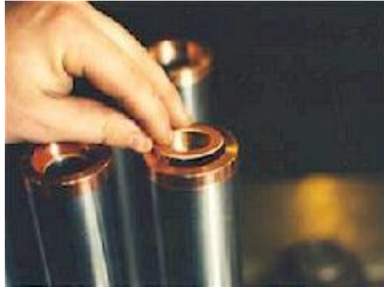
Figura 81: Posicionamiento de rotores y washer
