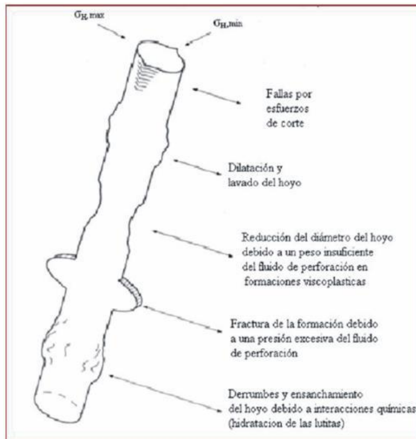
Figura. 2.14 Inestabilidad del hoyo
