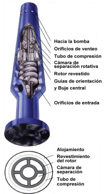
FIGURA 2.19 SEPARADOR DE GAS
