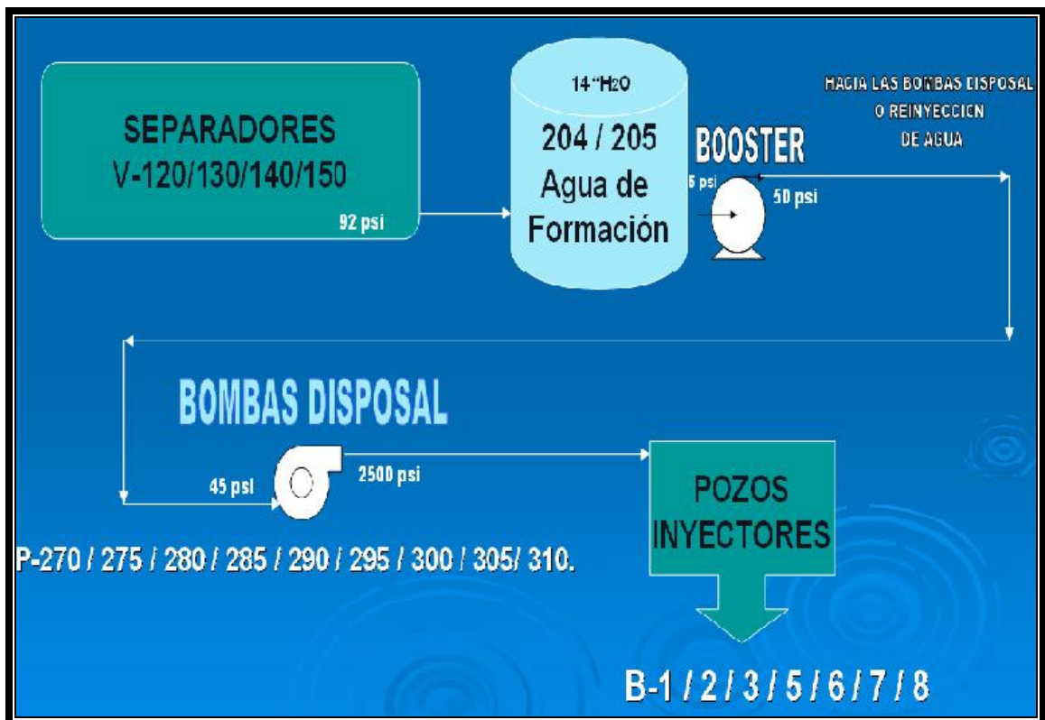
Figura N° 27. Esquema del proceso de inyección del agua de formación
