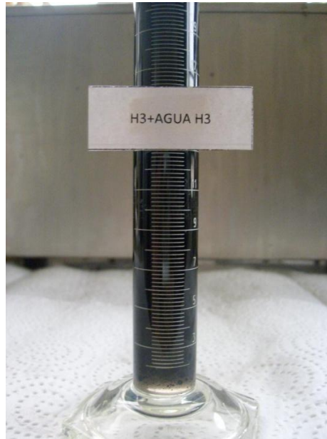
FOTO No 15. Agua de Formación H3 no tratada en emulsión con el crudo H-3 y con un 0% de separación
