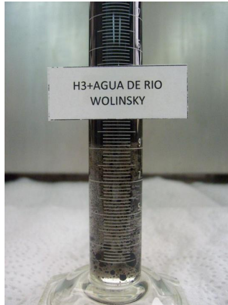
FOTO No 9. Agua de Río Wollinsky no tratada en emulsión con el crudo H-3 y con un 0% de separación
