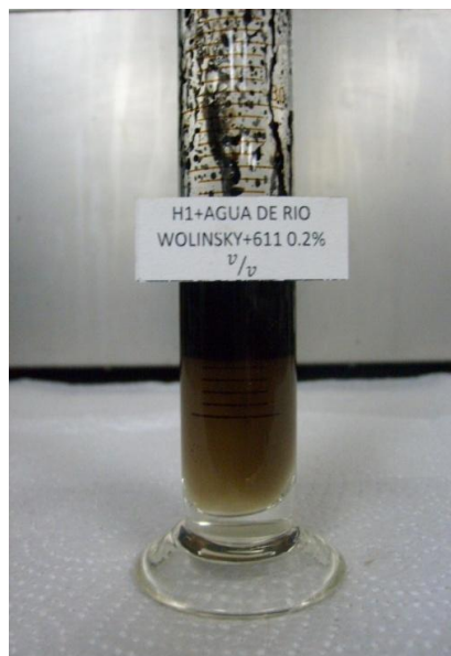
FOTO 2. Agua fresca de Río Wollinsky tratada en emulsión con el crudo H-1 y con una separación del 100%
