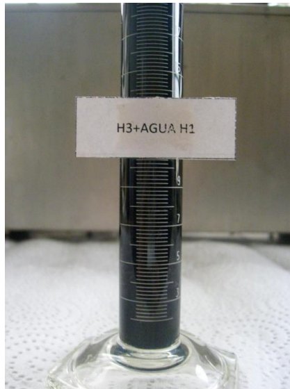
FOTO No 13. Agua de Formación H-1 no tratada en emulsión con el crudo H-3 y con un 0% de separación
