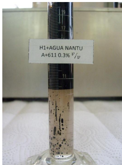
FOTO No 4. Agua de formación NANTU A tratada en emulsión con el crudo H-1 y con una separación del 98%
