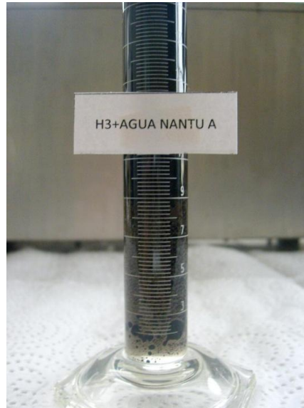
FOTO No 11. Agua de formación NANTU A no tratada en emulsión con el crudo H-3 y con un 0% de separación
