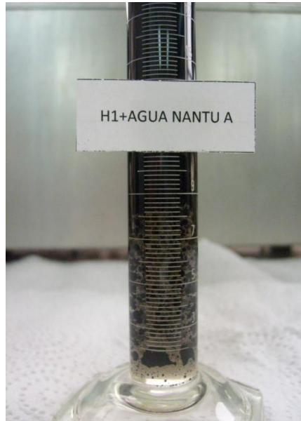
FOTO No 3. Agua de formación NANTU A no tratada en emulsión con el crudo H-1 y con un 0% de separación
