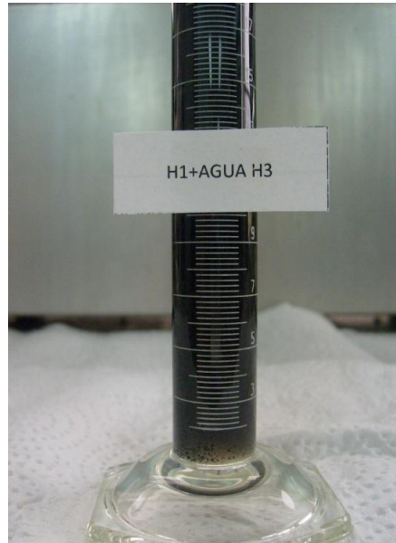
FOTO No 7. Agua de Formación H-3 no tratada en emulsión con el crudo H-1 y con un 0% de separación
