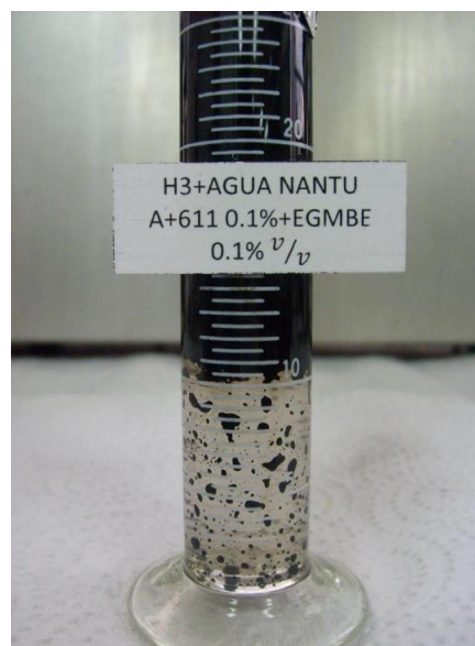
FOTO No 12. Agua de Formación NANTU A tratada en emulsión con el crudo H-3 y con una separación del 100%
