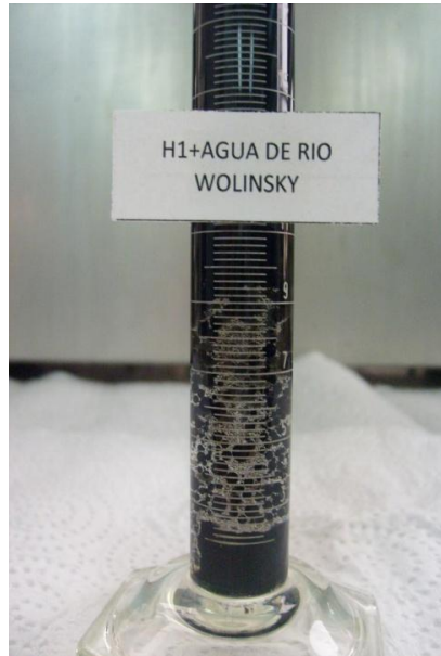
FOTO No 1. Agua fresca de Río Wollinsky no tratada en emulsión con el crudo H-1 y con un 0% de separación
