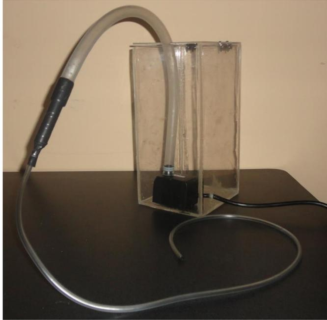
**Figura 89:** Contenedor de perfume en acrílico y bomba dosificadora.
