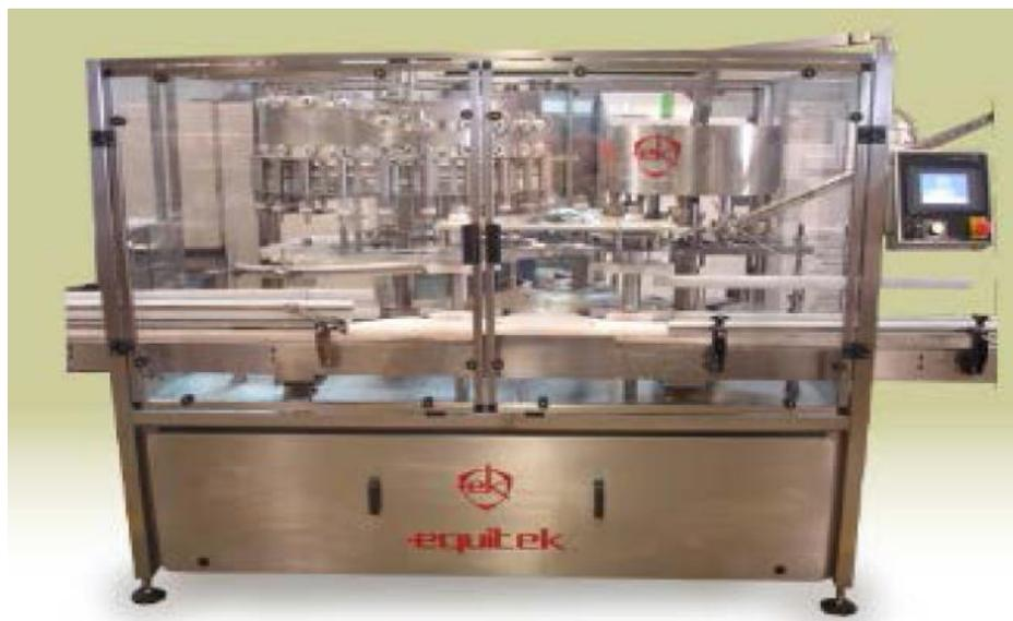
**Figura 8:** Modelo de envasadora rotativa por nivel.
