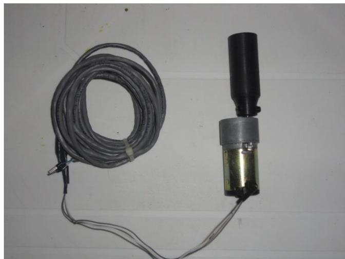
**Figura 79:** Selladora conformada por un motorreductor y un acople de duralón
