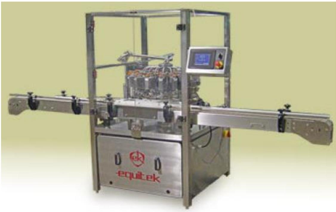
**Figura 9:** Modelo de envasadora rotativa por volumen.
