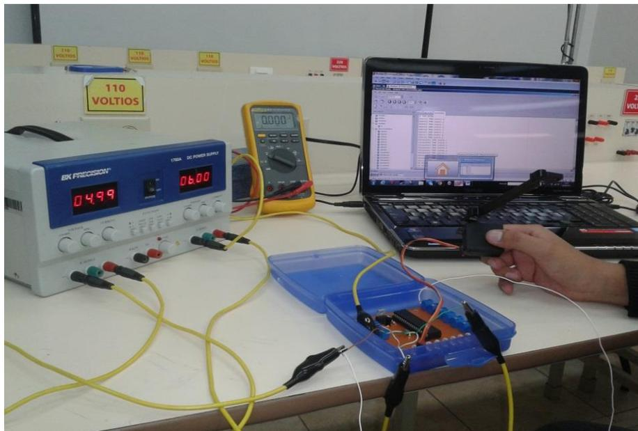
**Figura 84:** Pruebas en el Circuito de activación de servomotores.
