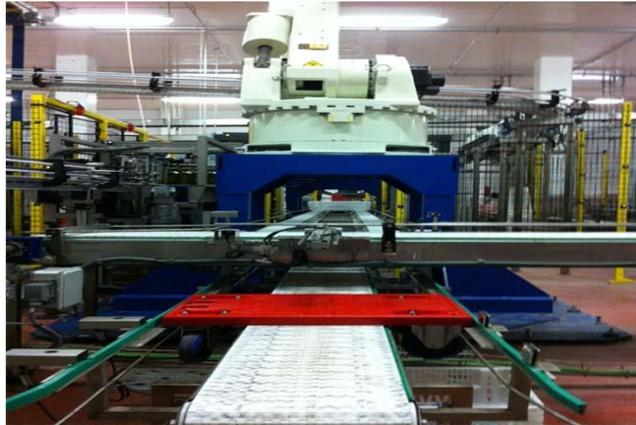
**Figura 22:** Transportadora de tipo modular
