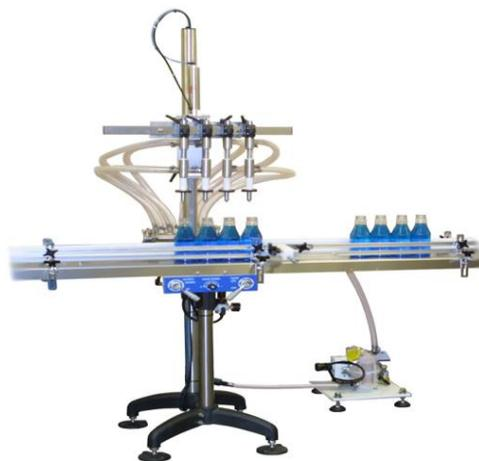
**Figura 4:** Modelo de envasadora de baja capacidad por nivel.
