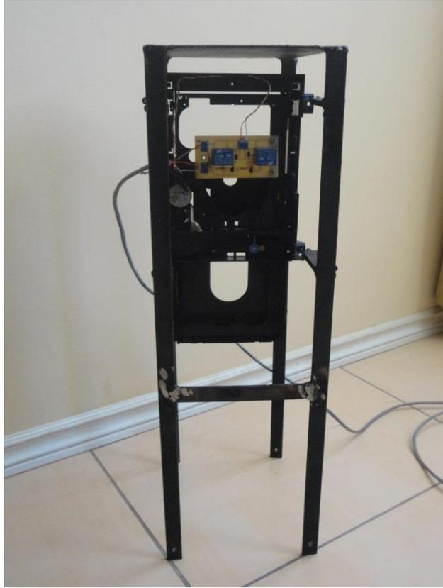
**Figura 78:** Base para el mecanismo de entrada y salida de la manguera dosificadora de perfume a la botella.
