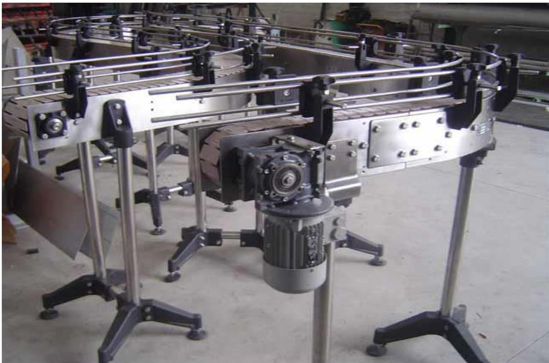
**Figura 21:** Transportadora de tipo Charnela
