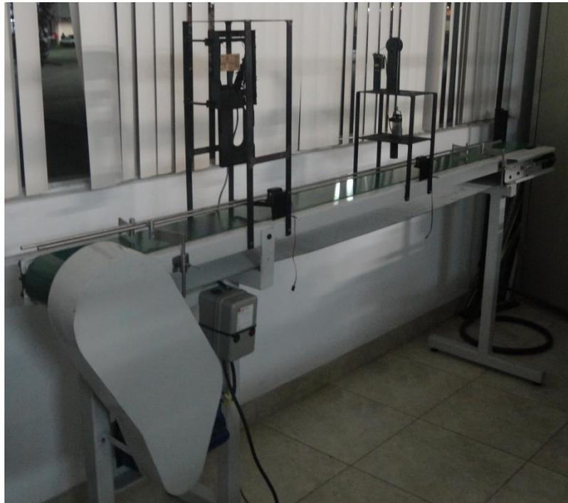
**Figura 90:** Banda transportadora con sistema de envasado y sellado de botellas de perfume.
