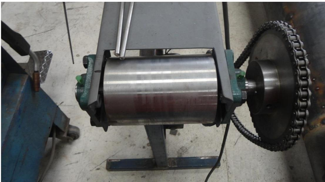
**Figura 75:** Instalación del rodillo principal y chumaceras.
