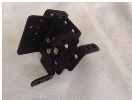
Figura 48. Unión de eslabones para movimiento de la muñeca
