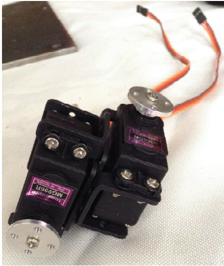
Figura 49. Servomotor en eslabones de movimiento de muñeca
