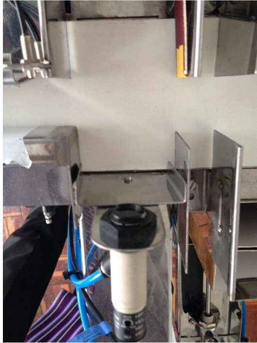
Figura 4.51. Sensor de presencia PR-R300NP tipo B, instalado (Loaiza, 2014)
