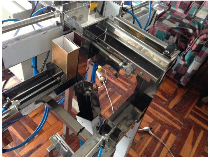
Figura 4.52. Posicionamiento de cajas para su empaquetamiento (Loaiza, 2014)
