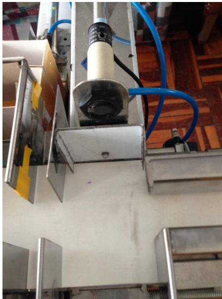
Figura 4.50. Sensor de presencia PR-R300NP tipo C, instalado (Loaiza, 2014)
