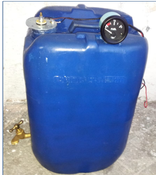
Figura 4.5 Tanque de combustible con reóstato, indicador y desfogue (Alvarez Ortiz, Diseño de gráficas, 2013)
