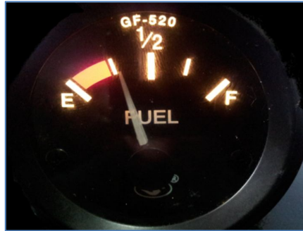
Figura 4.11 Medición de reserva de combustible del tanque (Alvarez Ortiz, Extracción y capturas de pantalla, 2013)
