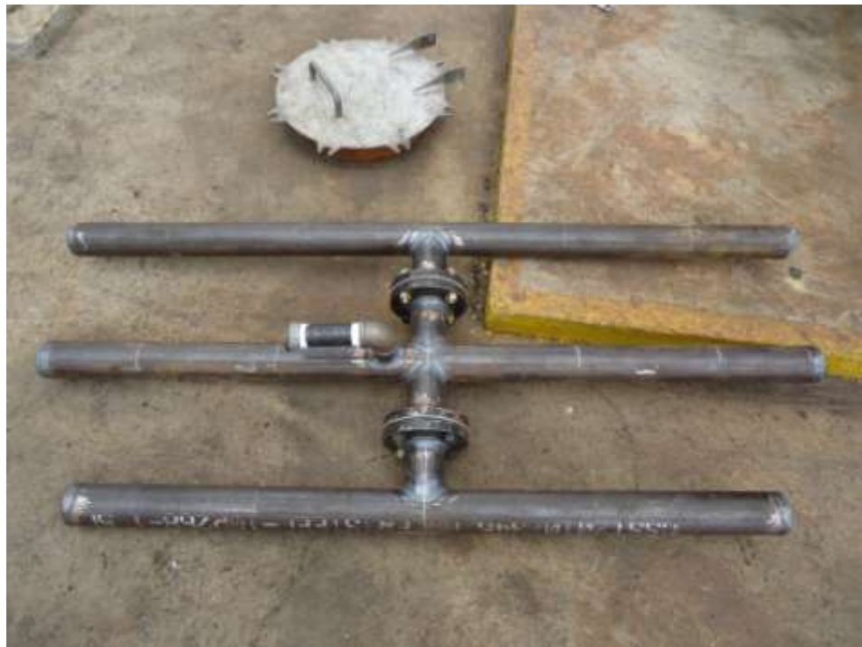
FIGURA21. Fotografía de la tubería del soplador de hollín
