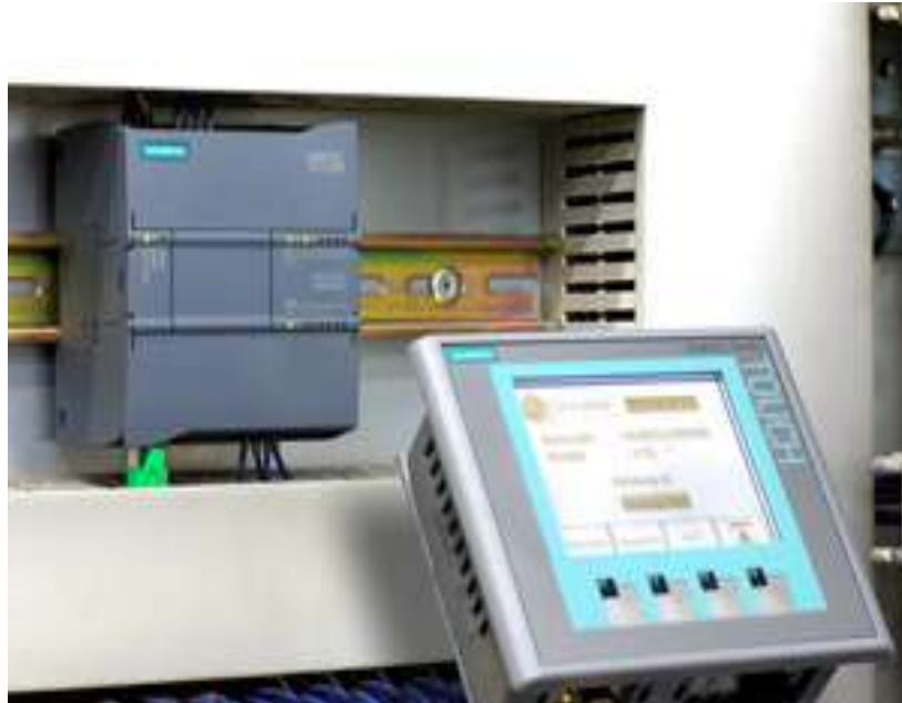
FIGURA39. Fotografía del SimaticHMIKTP 400
