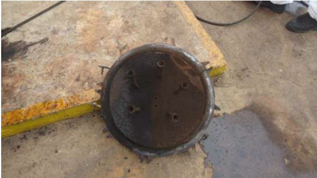
FIGURA18. Fotografía de la tapa de caldera modificada
