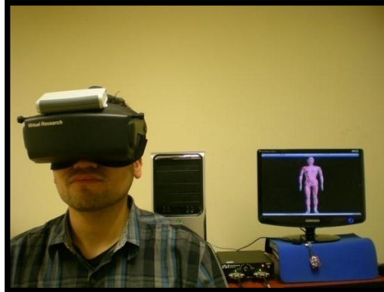
Figura 51. Posición de calibración para el modelo ejes X y Y en "0". (Romeo Rivadeneira, 2012)
