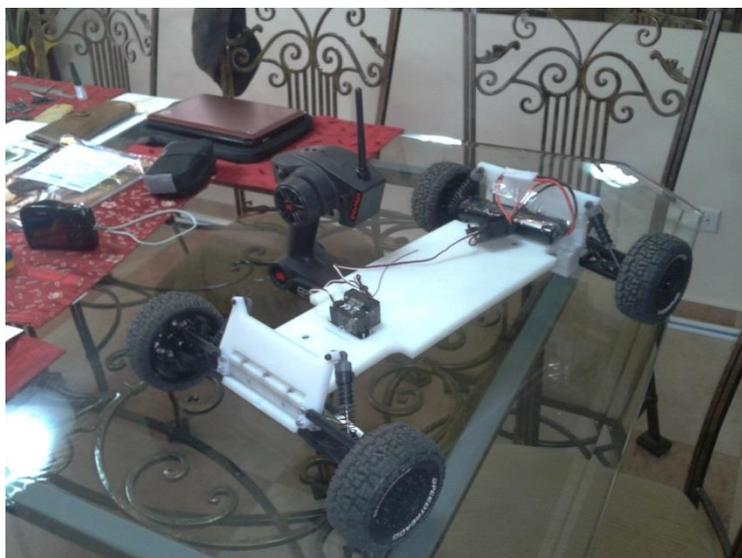
**Figura 49.** Instalación del motor, servo motor, receptor y control de velocidad.
