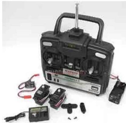
**Figura 6.** Control y Receptor
