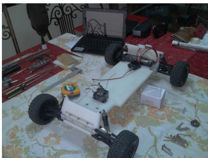
**Figura 50.** Instalación del motor, servo motor, receptor y control de velocidad 2.
