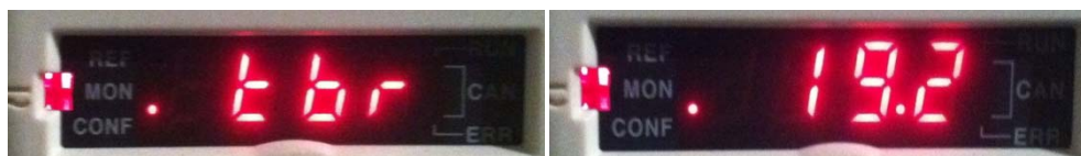
Figura 103. Velocidad de transmisión modbus.
