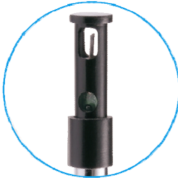
Figura 6. Anemómetro de Hilo Caliente, recuperado el 15 de diciembre del 2011 de http://www.ohdsa.com/anemometro_termoelectrico_hot_wire.html Anemómetro térmico, disponible para la medición velocidad de aire muy bajas OHD S.A.
