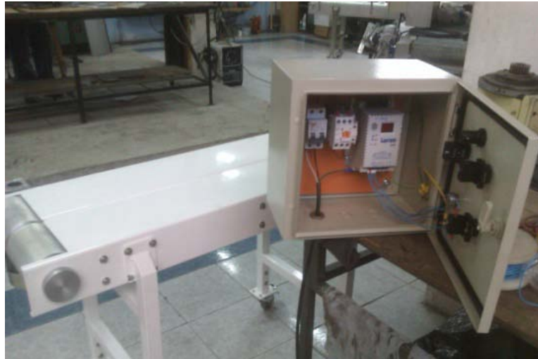
Figura N° 4. 14 Caja control de velocidad de la banda transportadora
