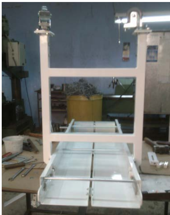
Figura N° 4. 11 Ensamble de la patas de la banda transportadora
