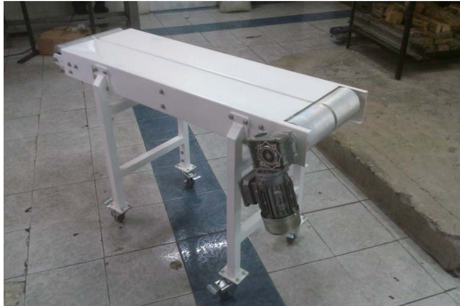
Figura N° 4. 12 Ensamble del motor en la banda transportadora
