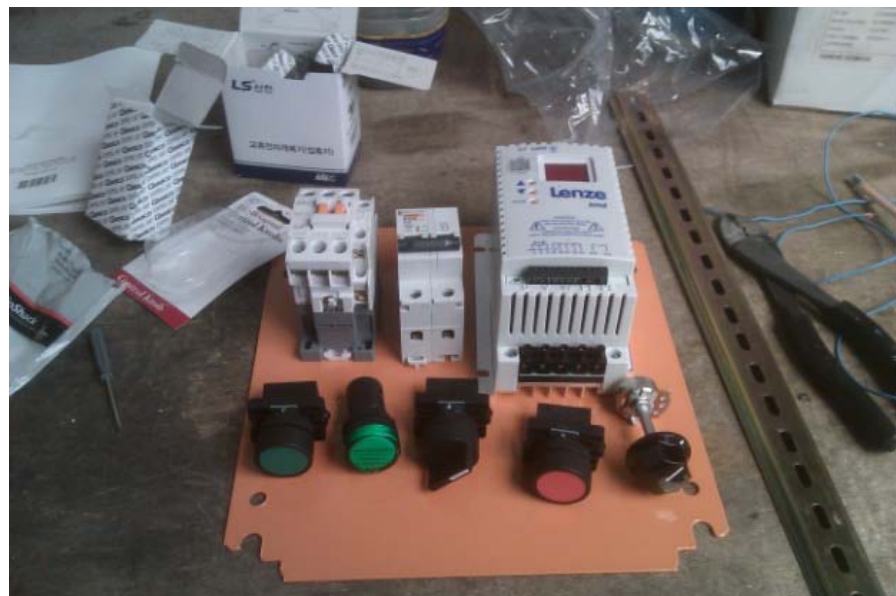
Figura N° 4. 13 Dispositivos de control de velocidad de la banda transportadora
