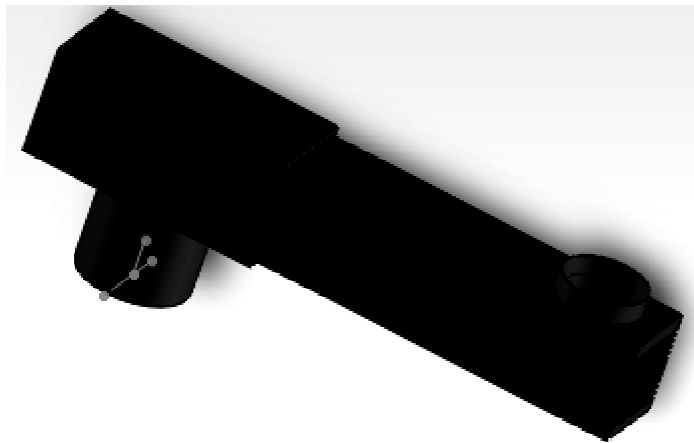
Figura 34. Brazo o eslabón uno con agarre para motor 2
