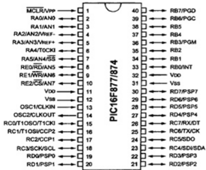
Figura 23. Pic 16f877A encapsulados y tipos de encapsulados, imagen tomada hoja de datos del PIC
