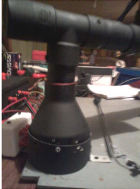
Figura 88. Base anclada a la tabla y con la caja de borneras listas
