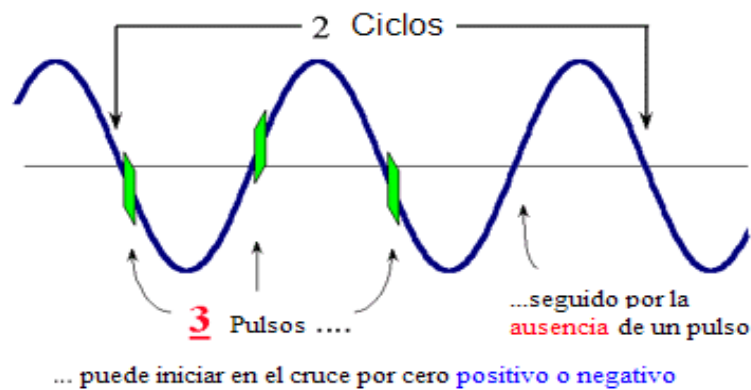
Figura No 7. Representación del Código de Inicio (Control de dispositivos a través de la red eléctrica)
