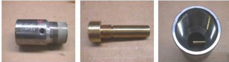
**Figura 2.29.** Válvula de Drenaje: pin y vista superior de la válvula
