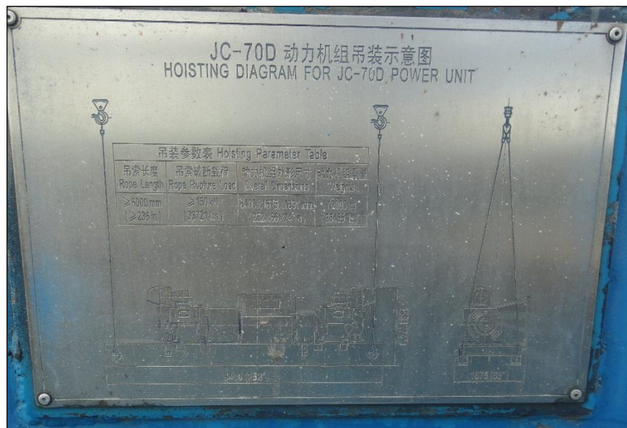
Figura 21. Placa del sistema de levantamiento ubicada en el malacate.
