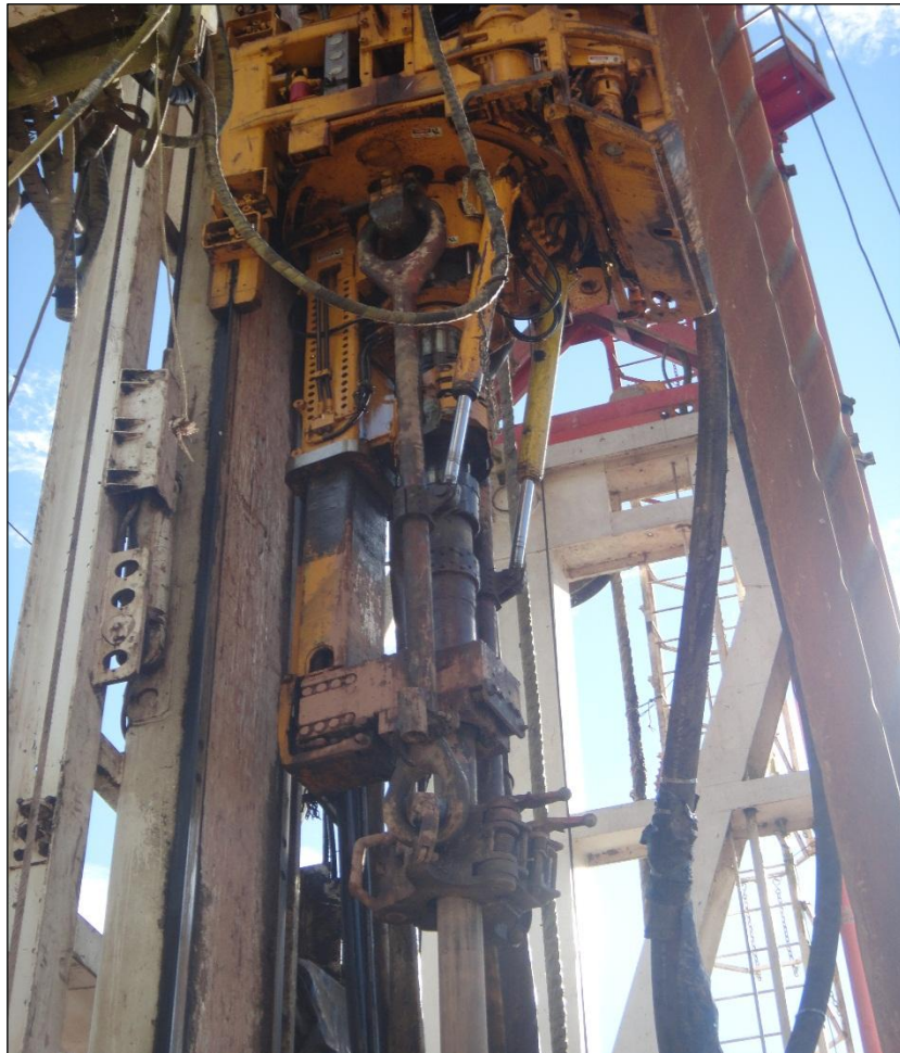
Figura 11. Brazos y elevadores de tubería.
