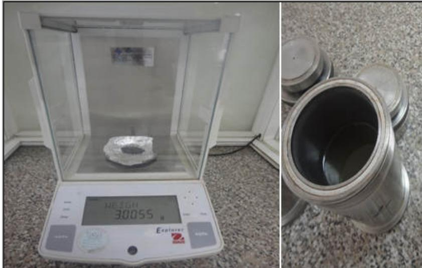
**Figura 3.16** Balanza analítica y Celda de rolamiento
