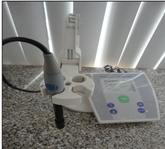
**Figura 3.11** Medidor de pH con electrodo
