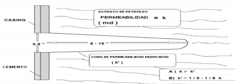
**Figura 2.10** Túnel típico de perforación, Perforación jet
