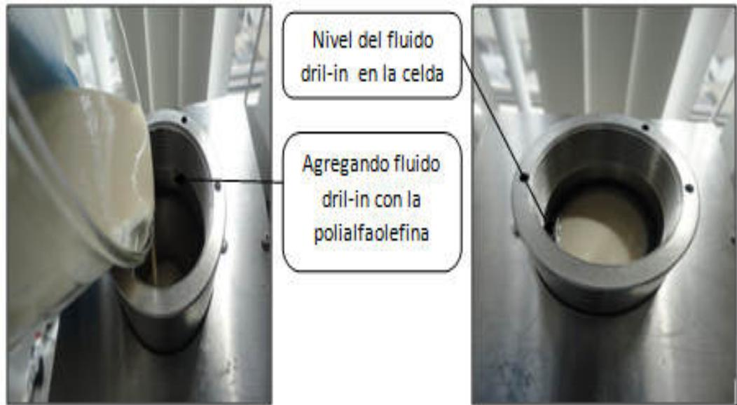
**Figura 3.28** Adición del fluido dril-in + polialfaolefina
