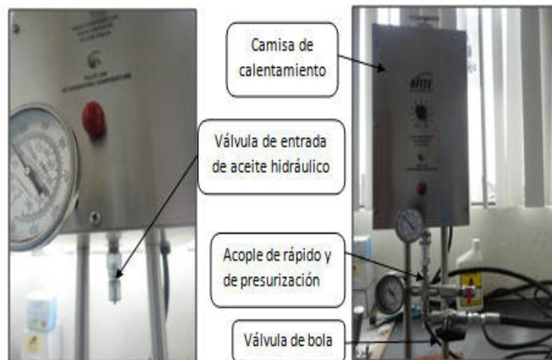
**Figura 3.26** Conexión de la válvula y manguera hidráulica a la tapa de entrada de la celda
