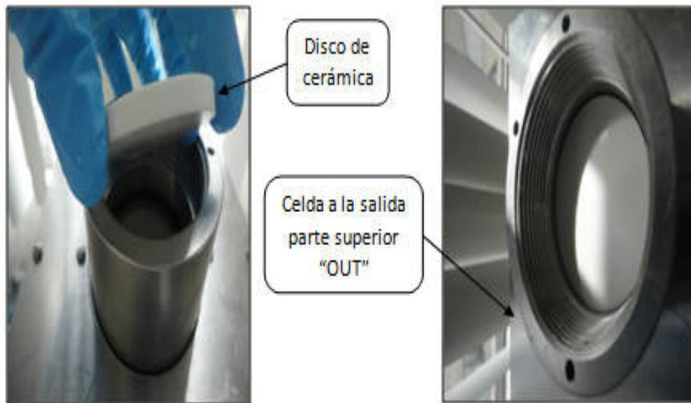
**Figura 3.29** Colocación del disco de cerámica o núcleo de formación
