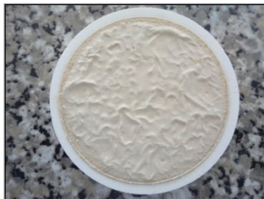
**Figura 4.9** Disco de cerámica de 750mD y garganta de poro de 5µm
