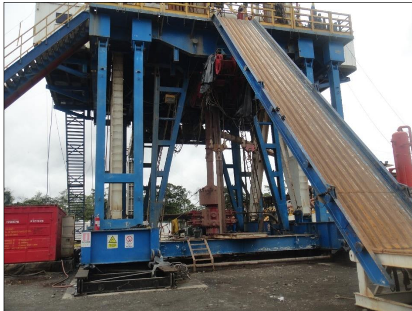
Figura 11. Subestructura de un mástil de perforación.
