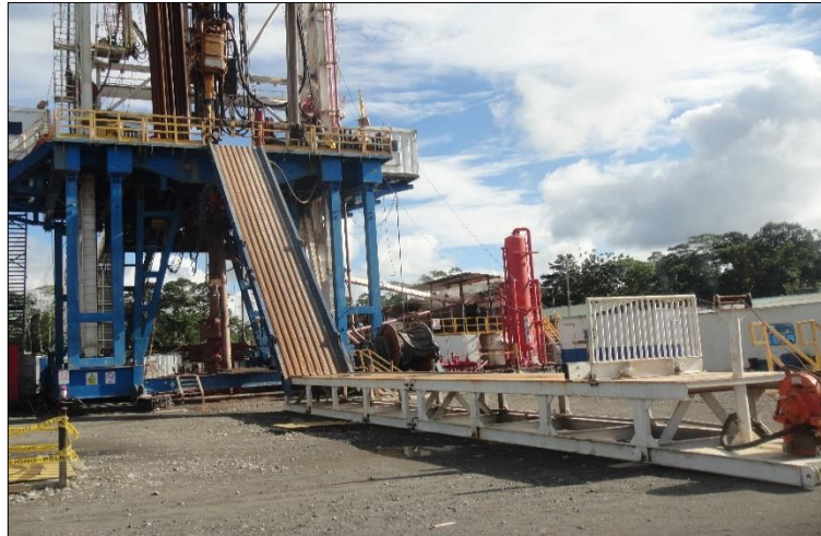
Figura 29. Planchada o rampa inclinada.
