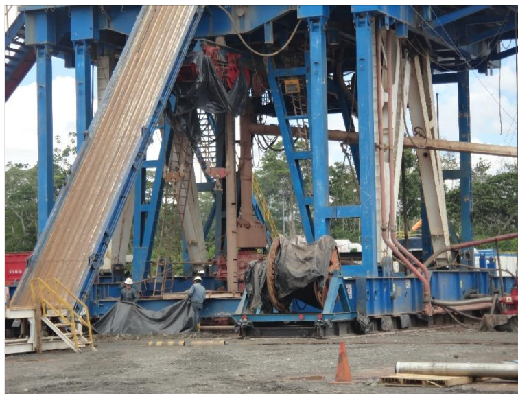
Figura 30. Cellar y subestructura.
