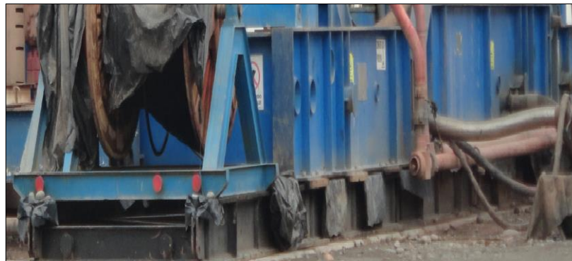
Figura 34. Rieles de la subestructura.
