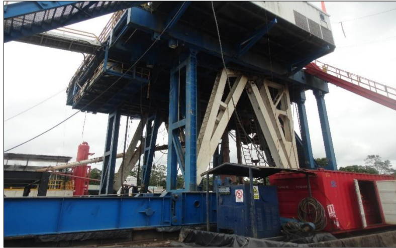
Figura 31. Soporte (patas) de la subestructura.
