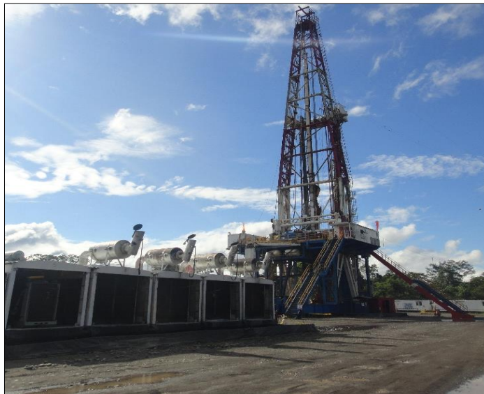
Figura 5. Sistema de generación y transmisión de potencia.
