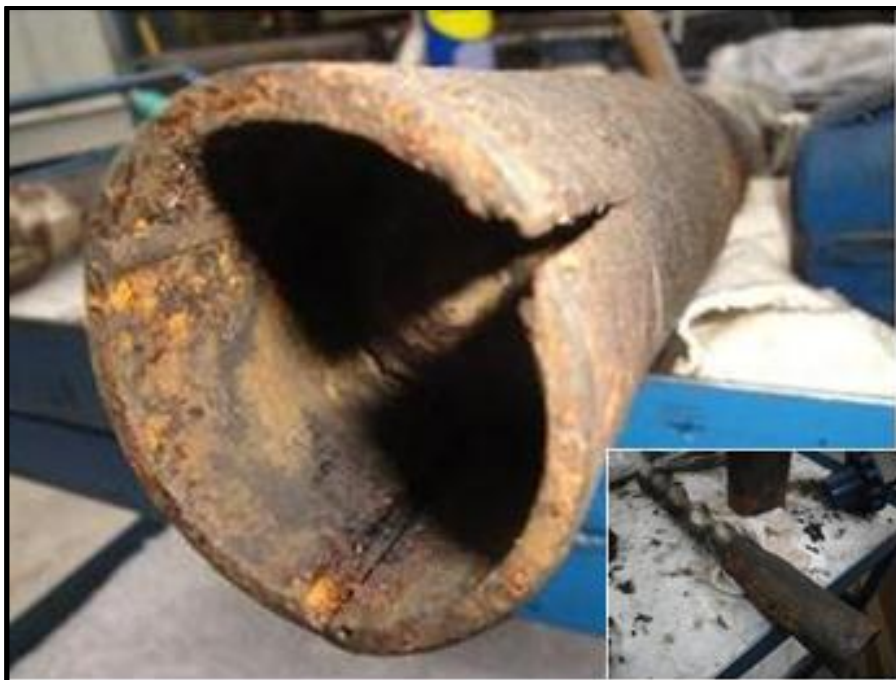
Figura 37. Coupling de conexión en rotor-flexshaft. (Respsol, 2013)
