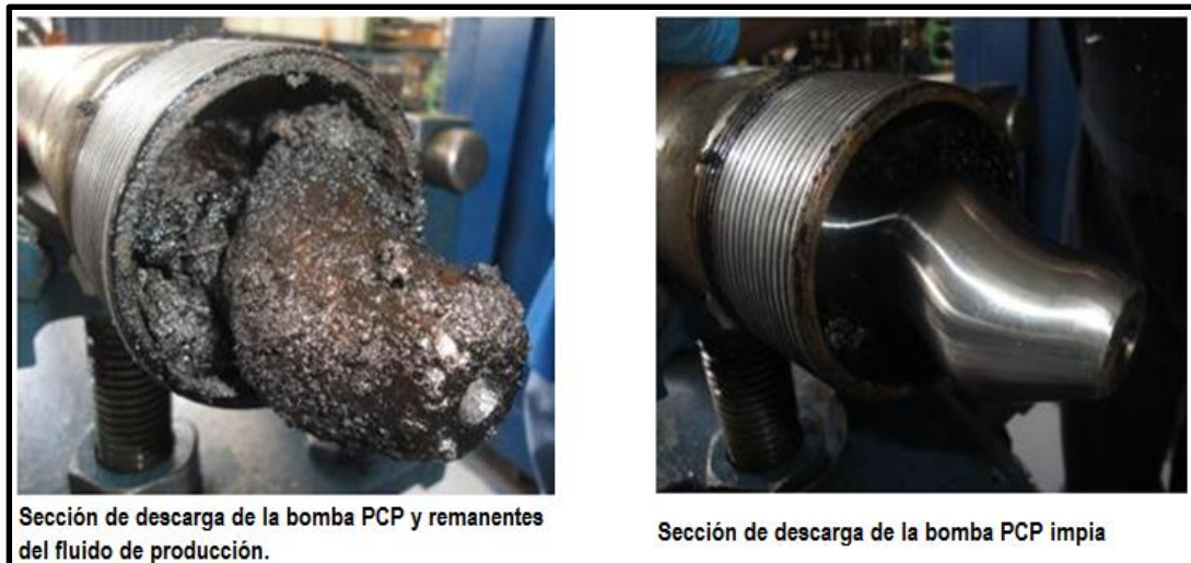
Figura 30. Sección de descarga de la bomba PCP. (Respsol, 2013)
