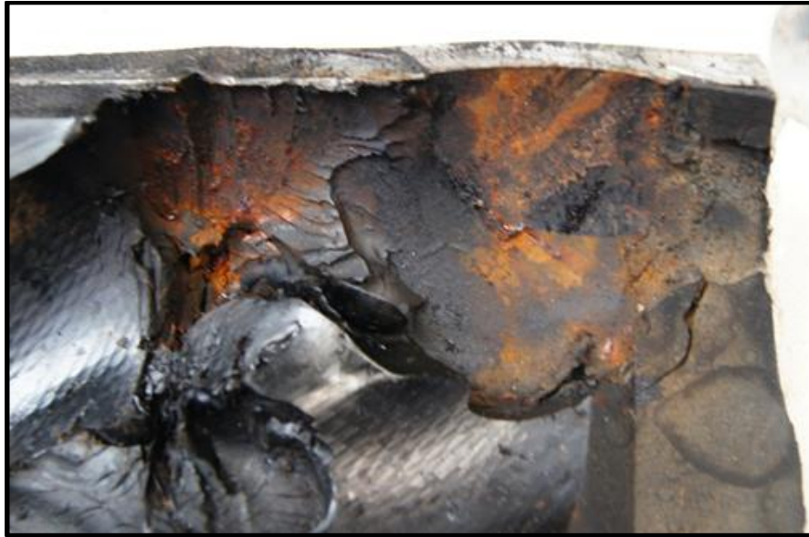
Figura 36. Corte transversal del housing zona de la fractura del rotor. (Respsol, 2013)
