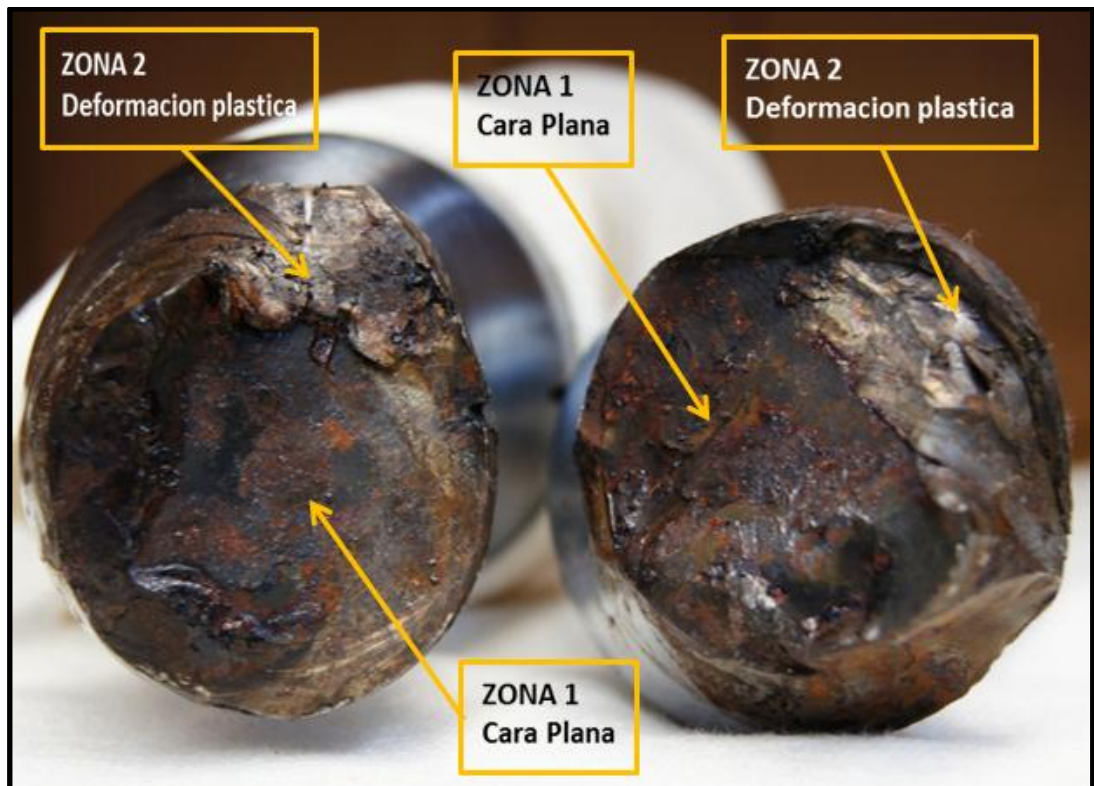
Figura 33. Corte transversal del rotor de la bomba PCP. (Respsol, 2013)
