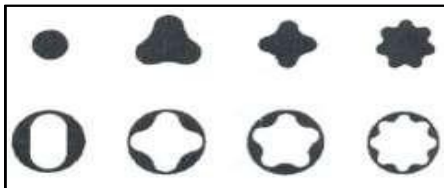
Figura 14. Tipos de eje Flexible para BESCP (Chacín, 2003)
