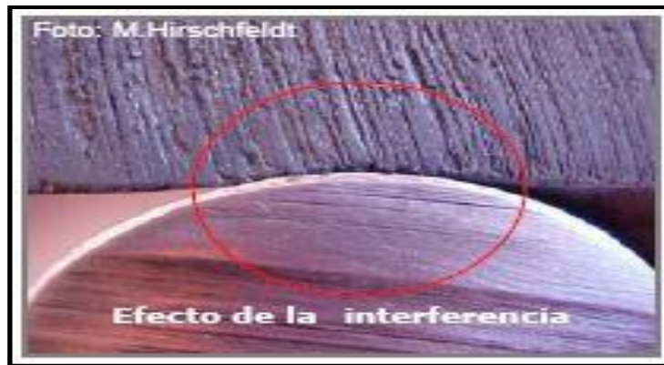
Figura 19. Fotografía de la Interferencia entre Rotor/Estator (Chacín, 2003)
