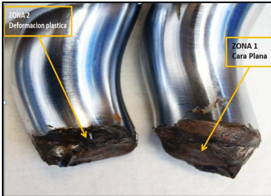
Figura 34. Corte perpendicular del rotor de la bomba PCP. (Respsol, 2013)
