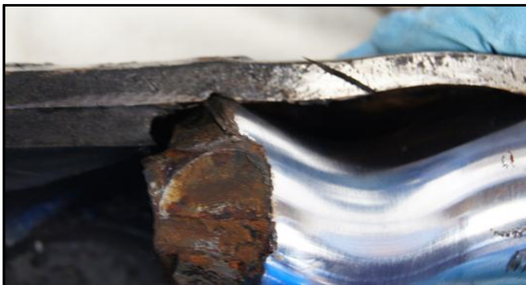
Figura 35. Corte perpendicular del housing y estado rotor de la bomba PCP. (Respsol, 2013)
