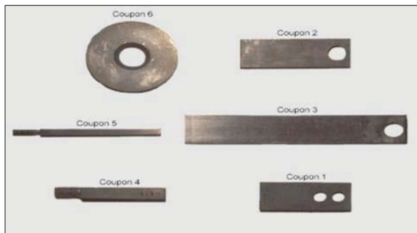
Figura 17. Cupones de Corrosión
