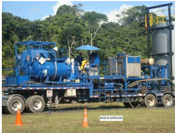
Fig. 3.1 Equipo de Acidificación
