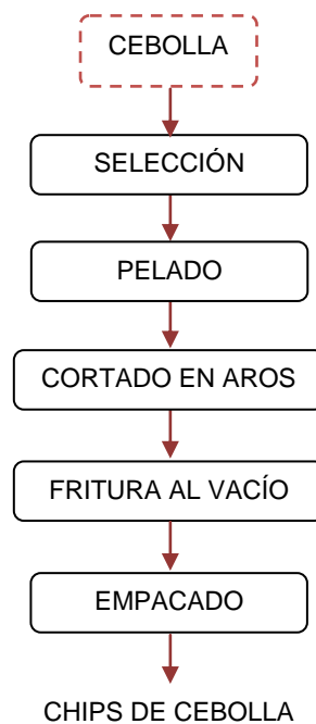
Figura 3.2. Esquema del proceso para la obtención de chips de cebolla aplicando fritura al vacío
