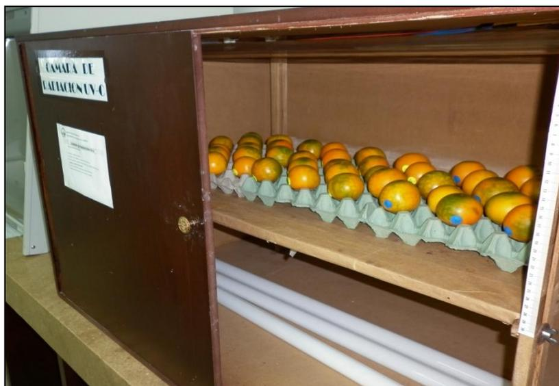
**Figura 4.** Cámara de radiación UV-C
