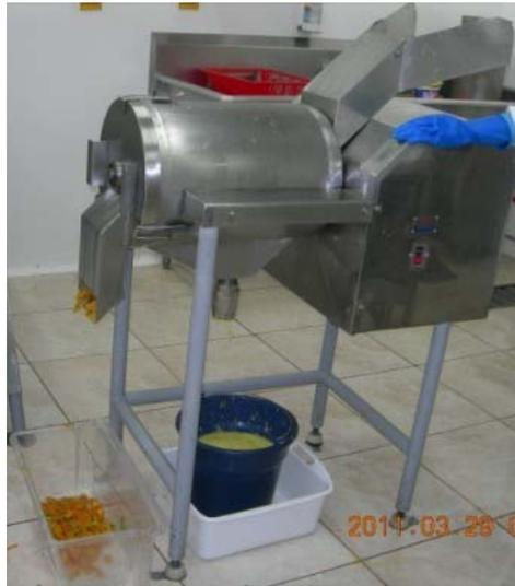
**Figura 15.** Despulpadora Proingal modelo DS-P001
