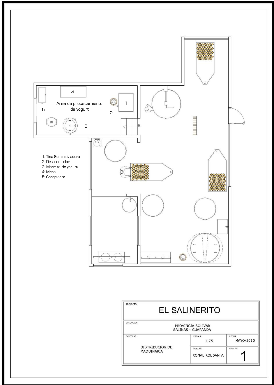
Gráfico 19. Plano de la planta de procesamiento
