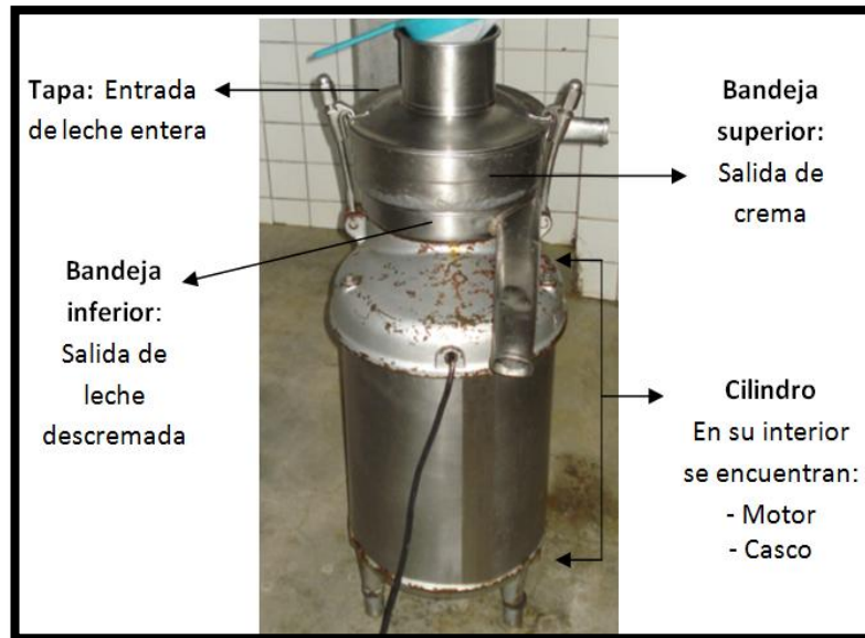
Foto 1. Partes de Descremador de leche
