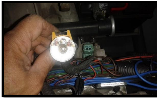
Figura 72. Prueba con leds comprobatorios de inyectores.
