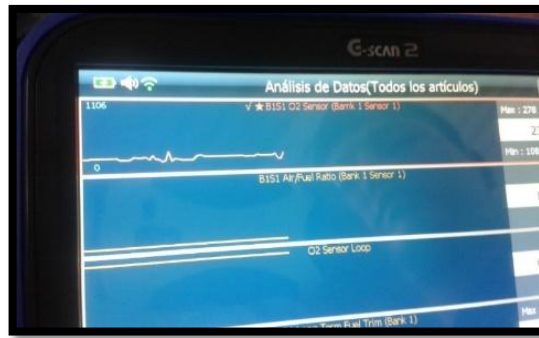
Figura 92. Lectura de funcionamiento del sensor de O2.
