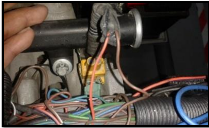
Figura 78. Conexiones al cuarto inyector al módulo de fallas.
