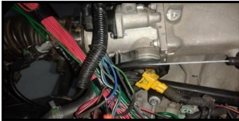
Figura 84. Conexiones de cableado al módulo.
