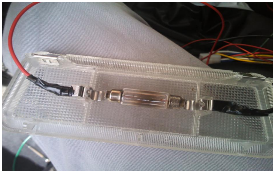
Figura 150. Conexión de las líneas de alimentación para la luz de salón
