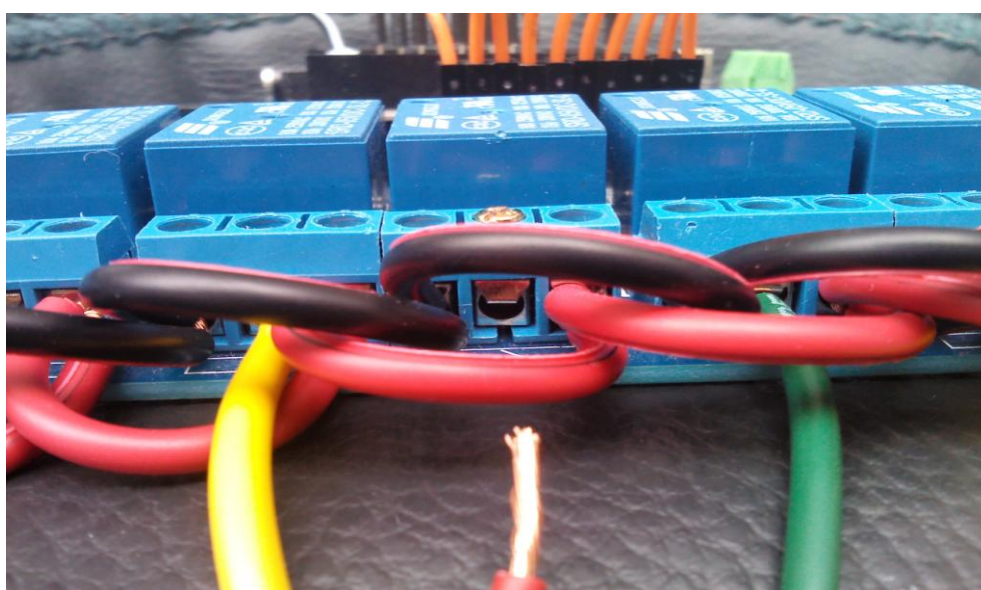
Figura 152. Relevador concerniente a la señal positiva de la bombilla de luz
