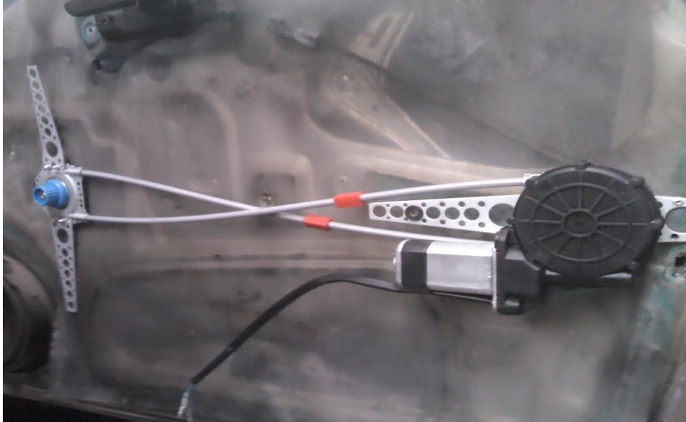
Figura 136. Implementación de seguros y elevallunas derecho
