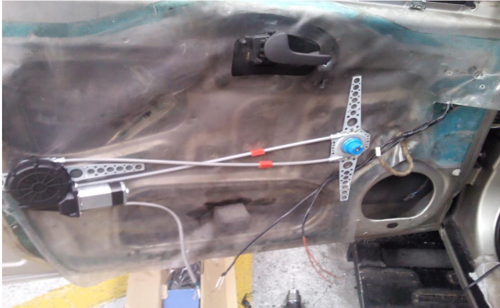
Figura 135. Implementación de seguros y elevallas izquierdo
