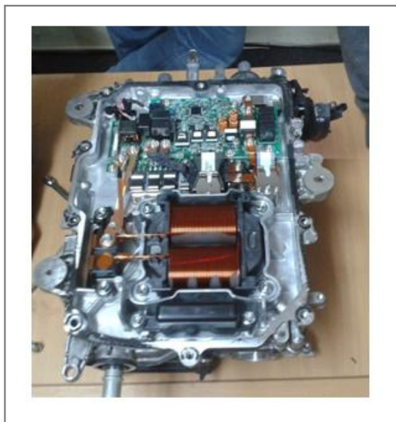
Figura 125. Conjunto inversor sin cubierta
