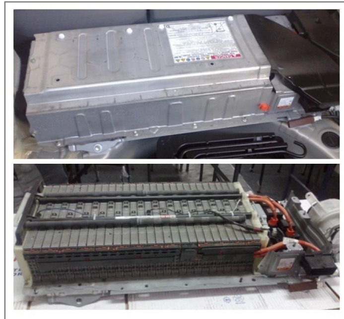
Figura 98. Batería de alto voltaje HV
