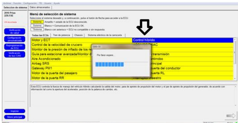
Figura 140. Ingresando al sistema de control híbrido
