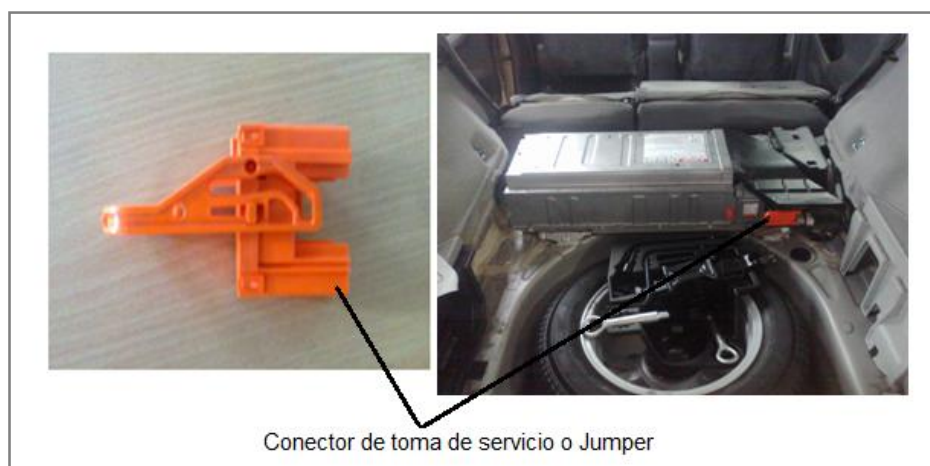
Figura 62. Toma de servicio o Jumper y ubicación en el vehículo
