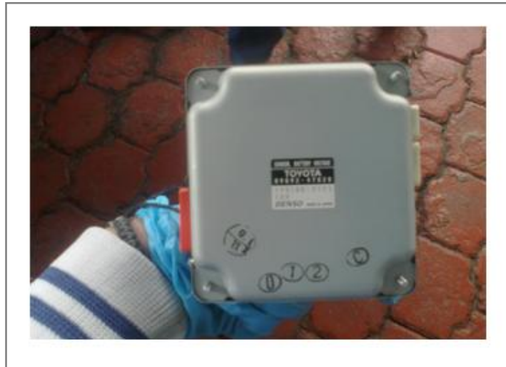
Figura 116. Identificación y limpieza externa de Unidad Inteligente de la Batería HV (ECU Batería HV)
