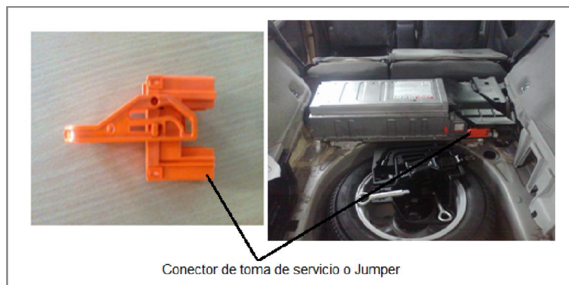
Figura 110. Toma de servicio o Jumper y ubicación en el vehículo
