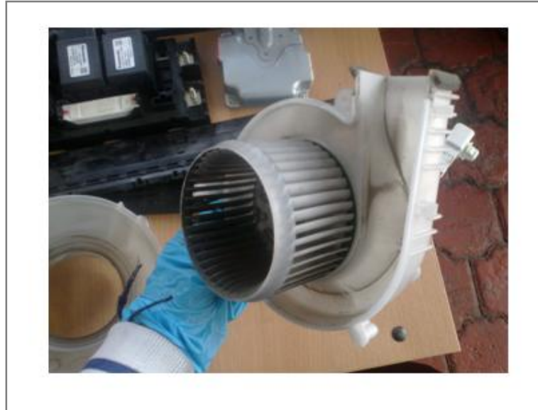
Figura 114. Identificación y limpieza externa de soplador de refrigeración
