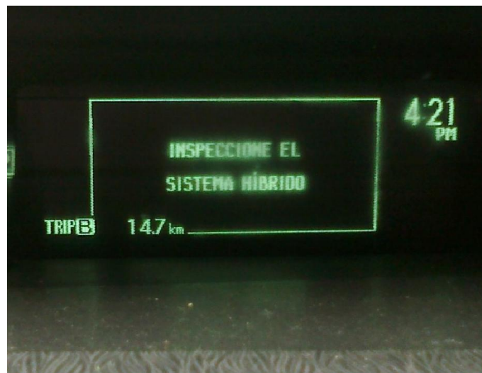
Figura 57. Presentación de falla del Sistema Híbrido en el tablero de instrumentos
