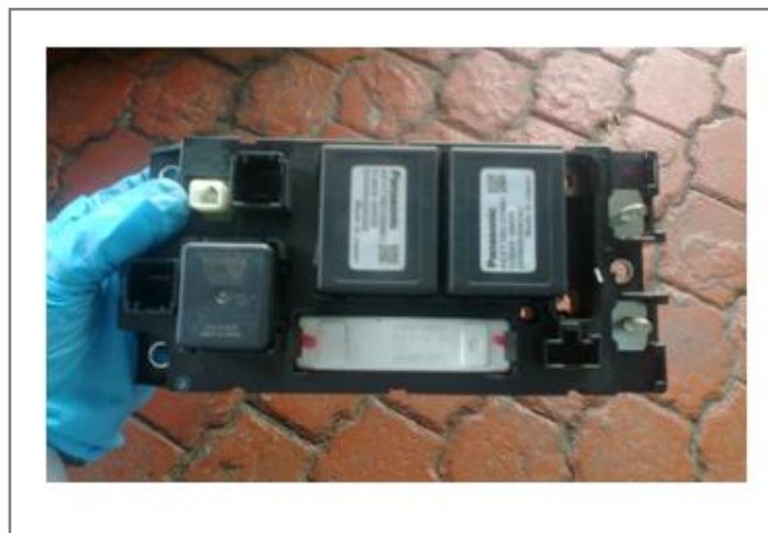
Figura 115. Identificación y limpieza externa de conjunto de relevadores
