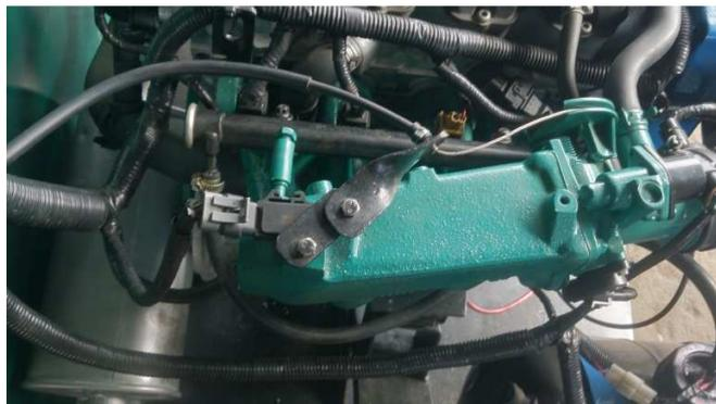
**Figura 28.** Cable de aceleración
