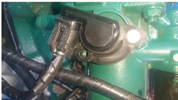
**Figura 41.** Ubicación del Sensor TPS
