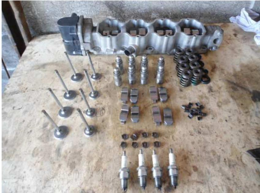
**Figura 25.** Motor desarmado
