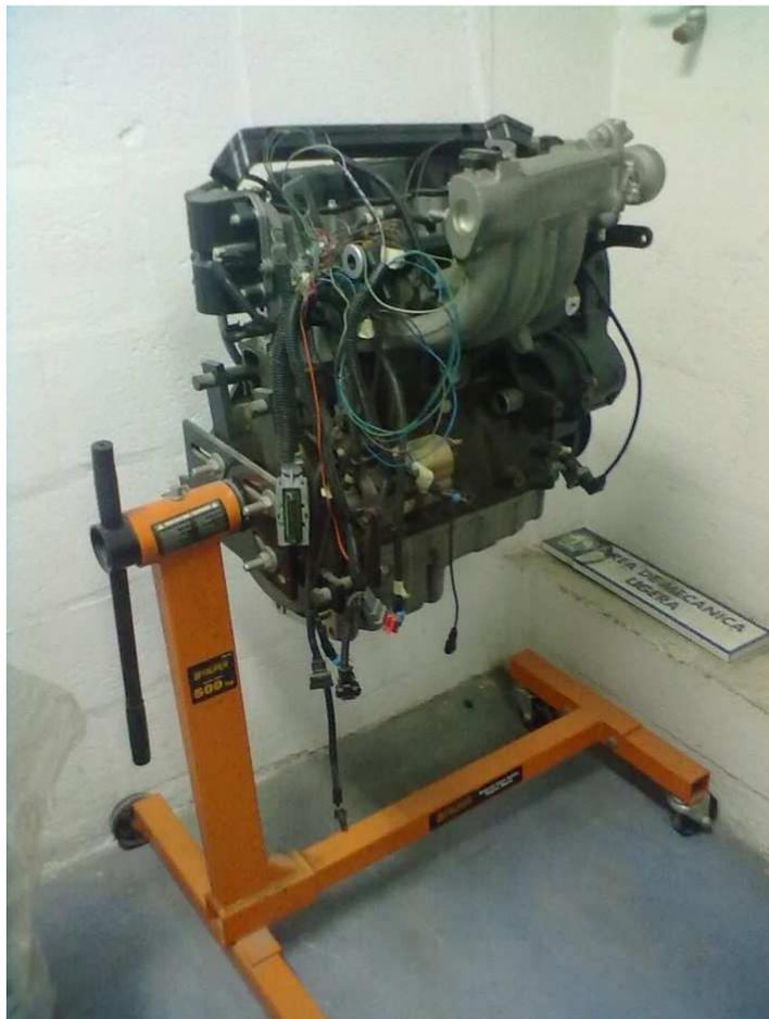
**Figura 1.** Motor Corsa 1.4
