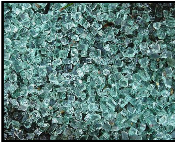
Figura 62. Fragmentos de vidrio templado (Vidrio perfil, 2013)
