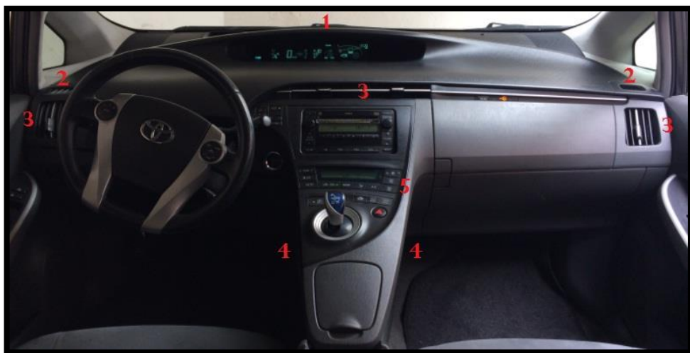
Figura 68. Disposición del conjunto climatizador en el panel de instrumentos
