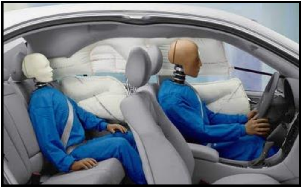
Figura 53. Airbag lateral pasajeros (Autotec, 2011)
