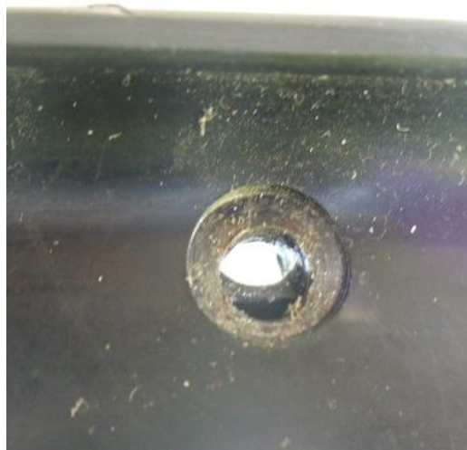
Figura 3.34. Perforación en la base del asiento de seguridad infantil
