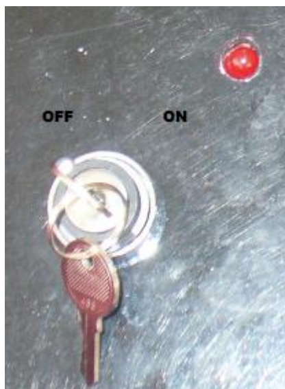
Figura 3.49. Switch de ignición con luz de control
