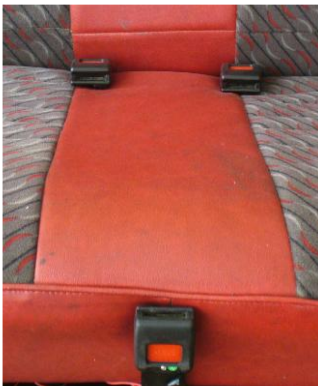
Figura 3.9. Enganches de hebillas adaptados en el asiento posterior del vehículo
