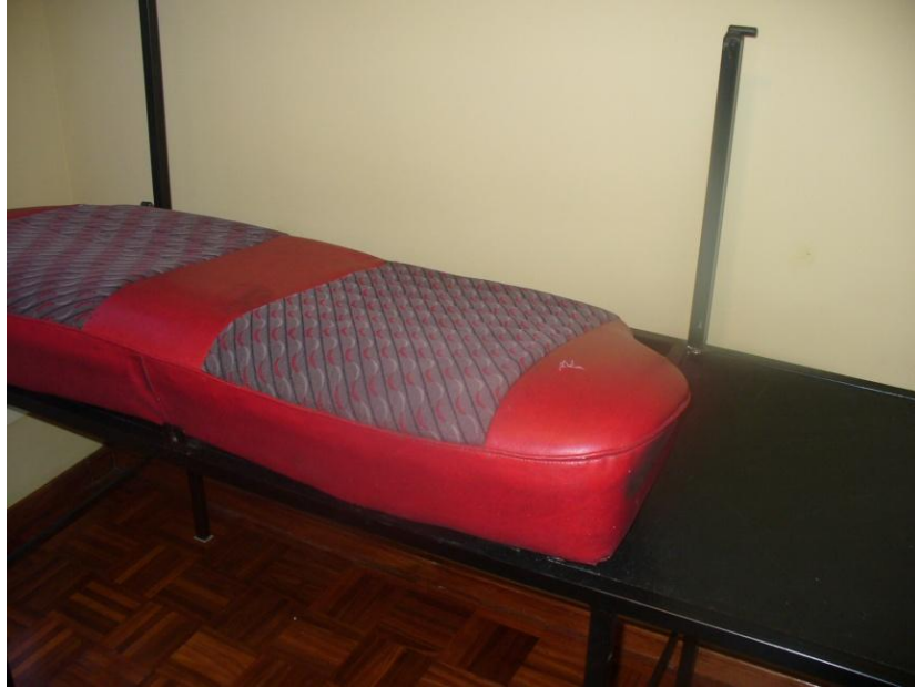
Figura 3.28. Sujeción del cojín del asiento posterior en la estructura metálica
