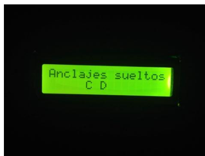
Figura 4.15. Mensaje en el display de Anclajes sueltos
