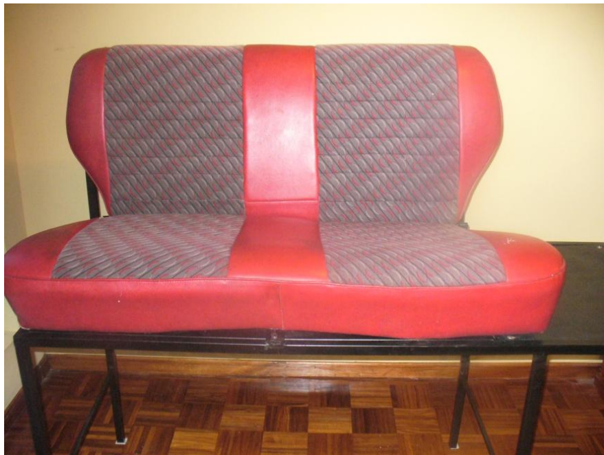
Figura 3.29. Sujeción del espaldar del asiento posterior en la estructura metálica
