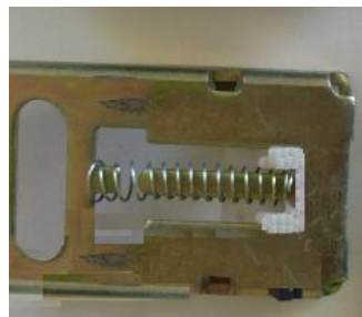
Figura 3.38. Parte metálica del enganche de hebilla
