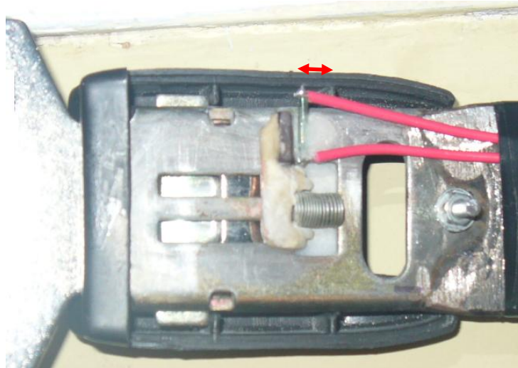
Figura 3.42. Enganche de hebilla en posición de anclaje total
