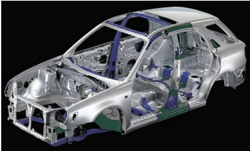
Figura 2.20. Zonas reforzadas en la carrocería del vehículo (Águeda, García, Gómez, & Martín, 2010)
