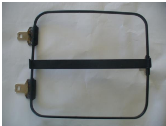
Figura 3.32. Armazón sujeta hebillas
