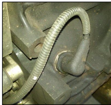
Figura 30. Sensor de posición del cigüeñal CKP
