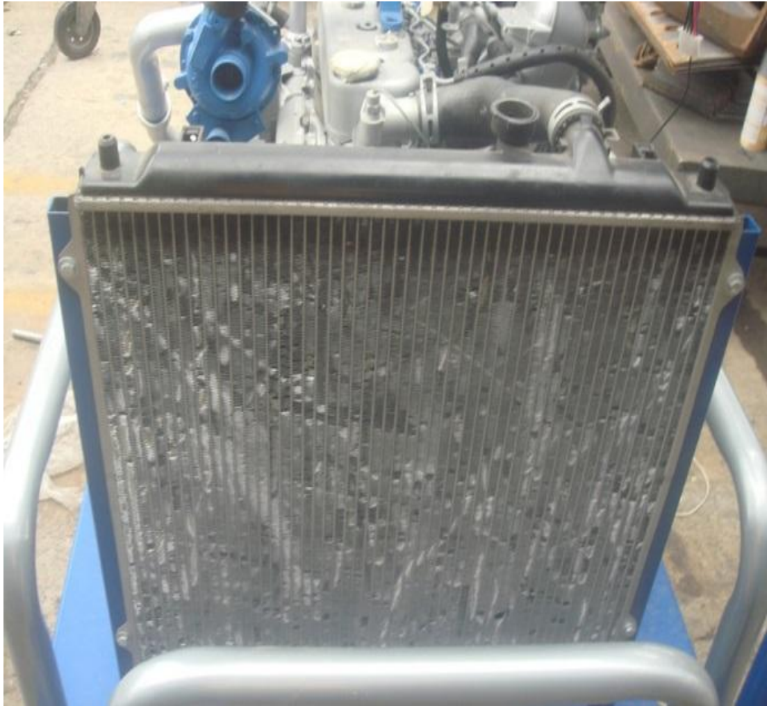
Figura 75. Radiador adaptado al motor
