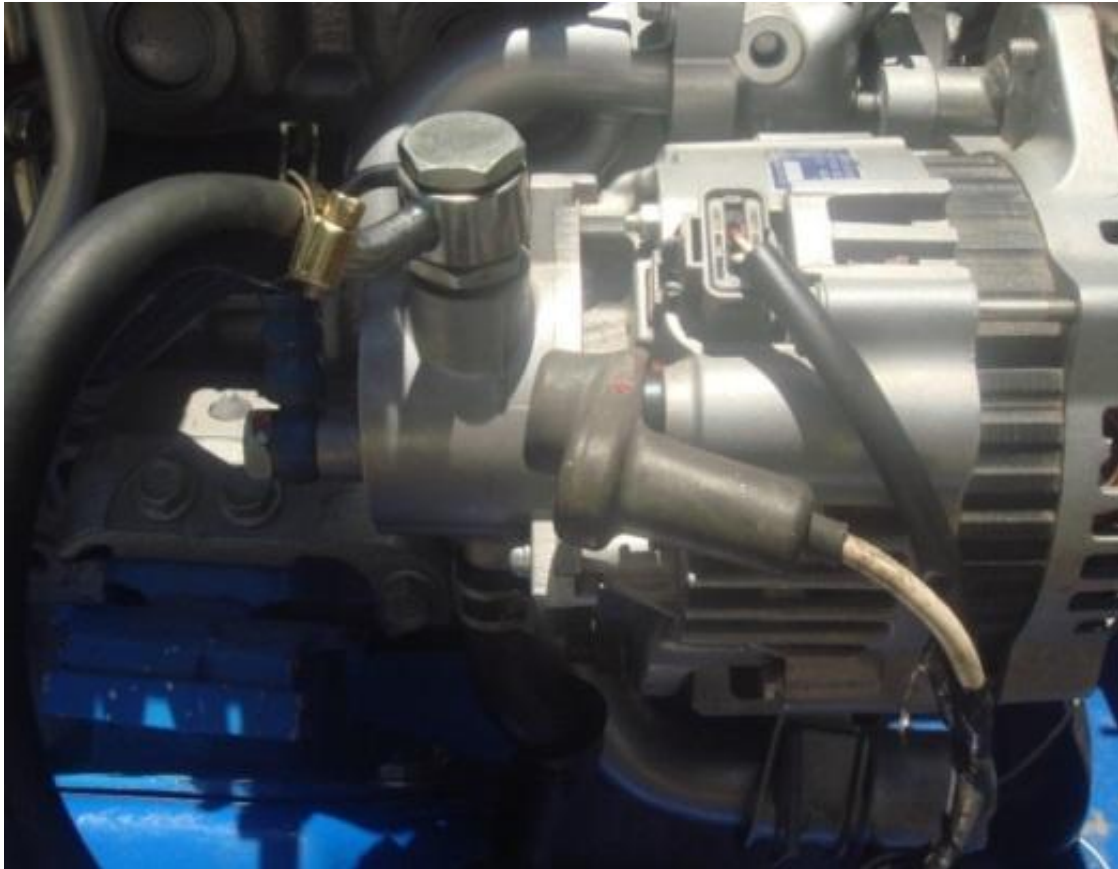
Figura 80. Toma a la salida de la bomba vacío para el vacuómetro.
