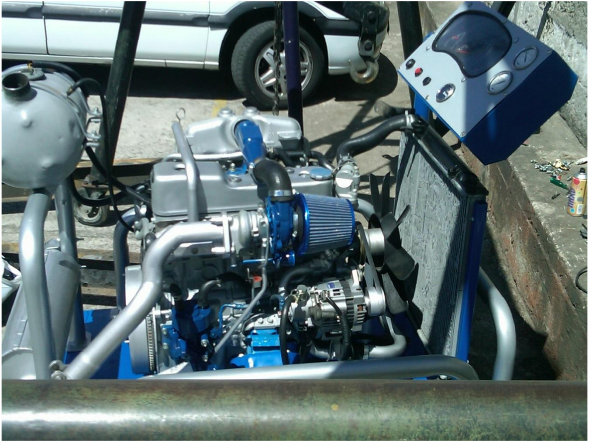
ANEXO 5: Banco didáctico terminado, con el tablero de instrumentos.
