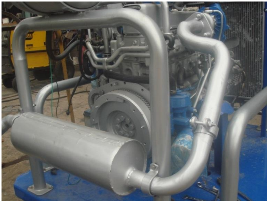
Figura 74. Sistema de escape adaptado
