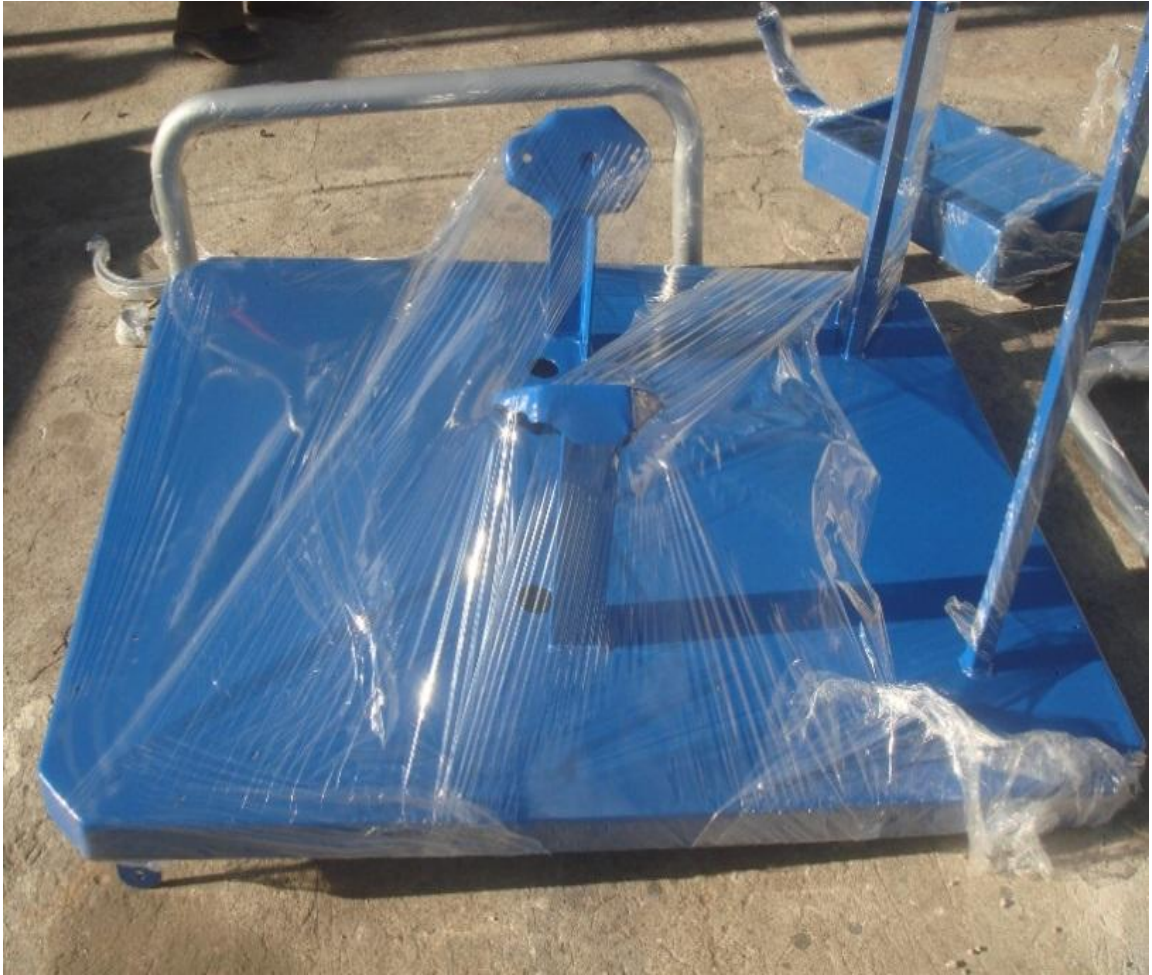
Figura 68. Bastidor del motor finalizado con la pintura electrostática
