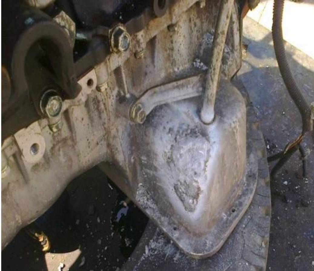
Figura 61. Relleno del orificio del cárter
