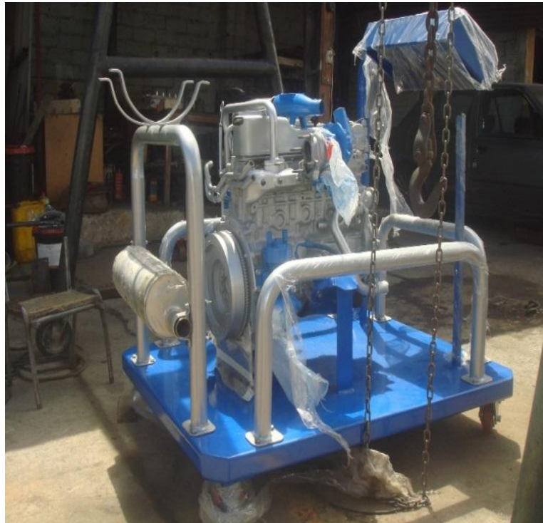
Figura 72. Montaje del motor en el bastidor
