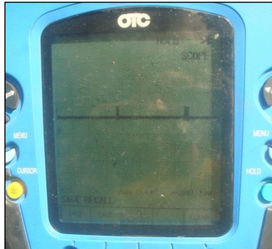
Figura 47. Oscilograma del Bus CAN HIGH del Módulo de la Bomba
