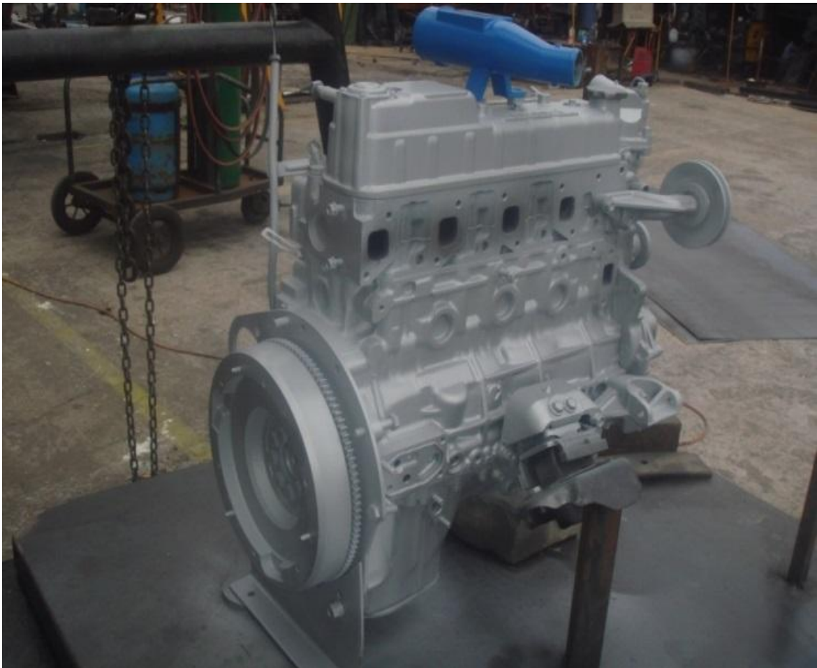
Figura 71. Trabajo final de pintura del block
