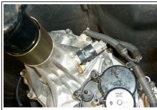
Figura 57. Sensor de Velocidad VSS (ISUZU MOTORS LIMITED, 2003)
