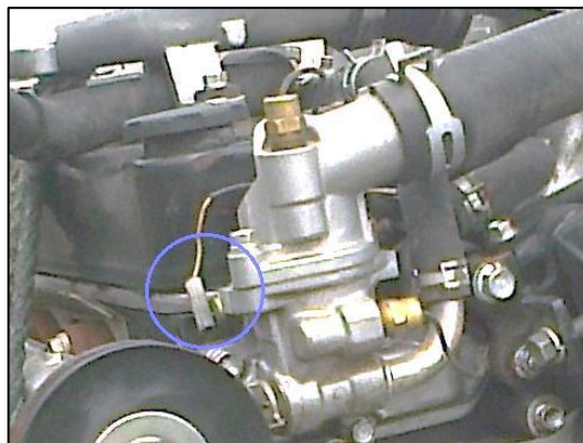
Figura 33. Sensor de temperatura de refrigerante ECT
