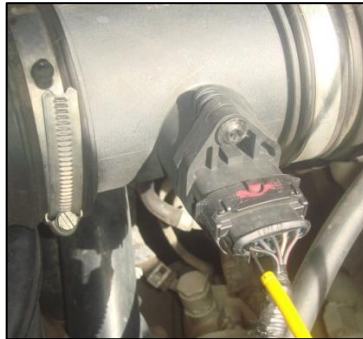
Figura 31. Sensor de masa de aire MAF y sensor IAT
