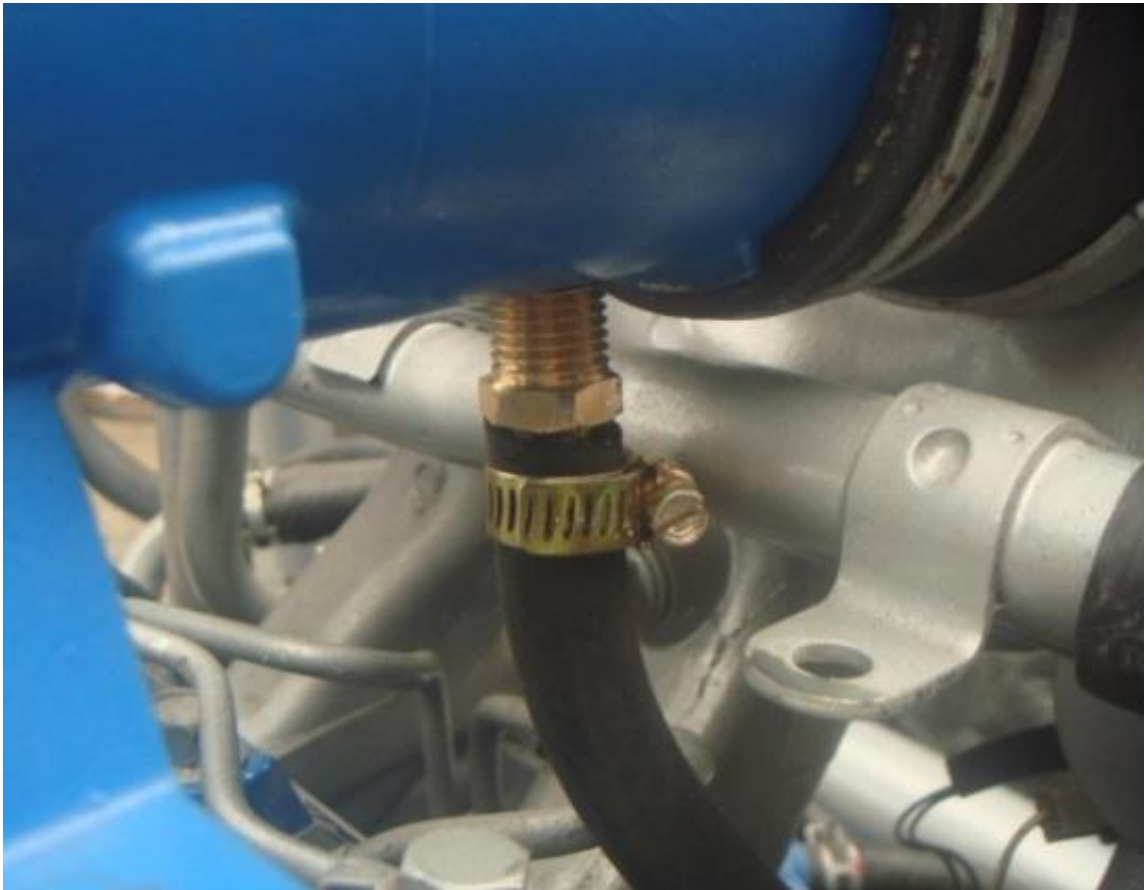
Figura 79. Toma para el manómetro de presión e turbo
