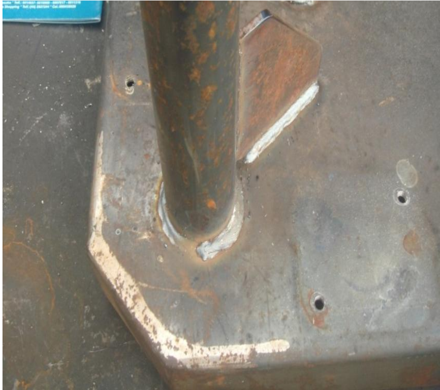
Figura 67. Proceso de soldadura MAG
