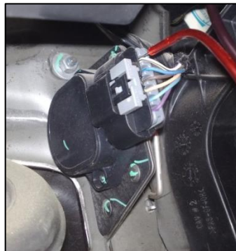
Figura 29. Sensor de posición de mariposa de aceleración APP
