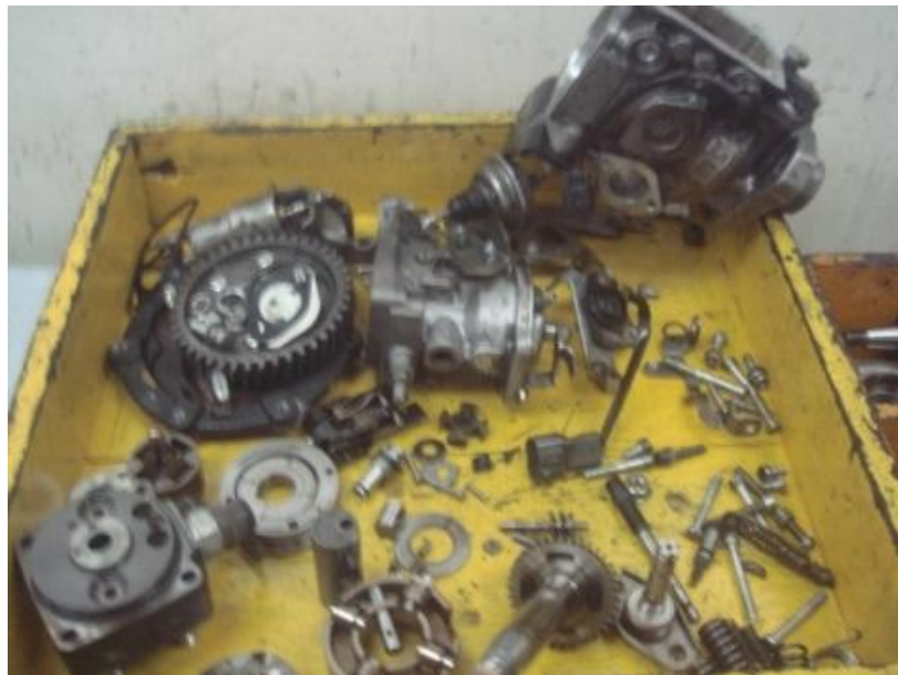
Figura 88. Despiece de la bomba de inyección rotativa
